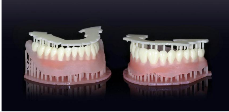
Slika 14 – 3D ispisano zubalo [23]
