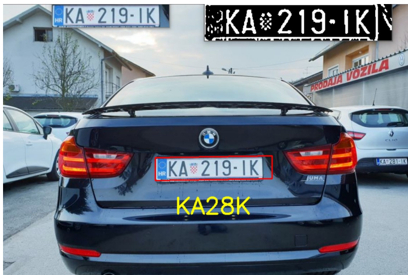
Slika 38. Djelomična detekcija – primjer 1
