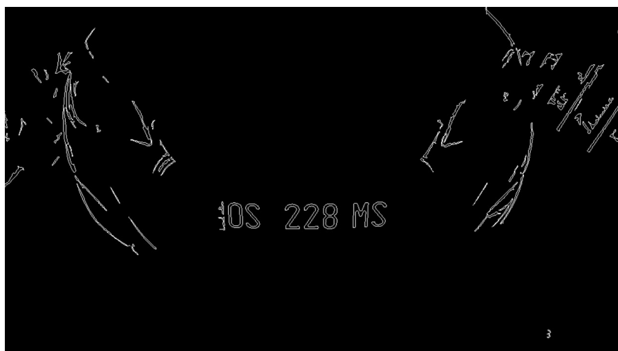
Slika 11. Osobni automobil – sužavanje područja na moguće registracijske oznake
