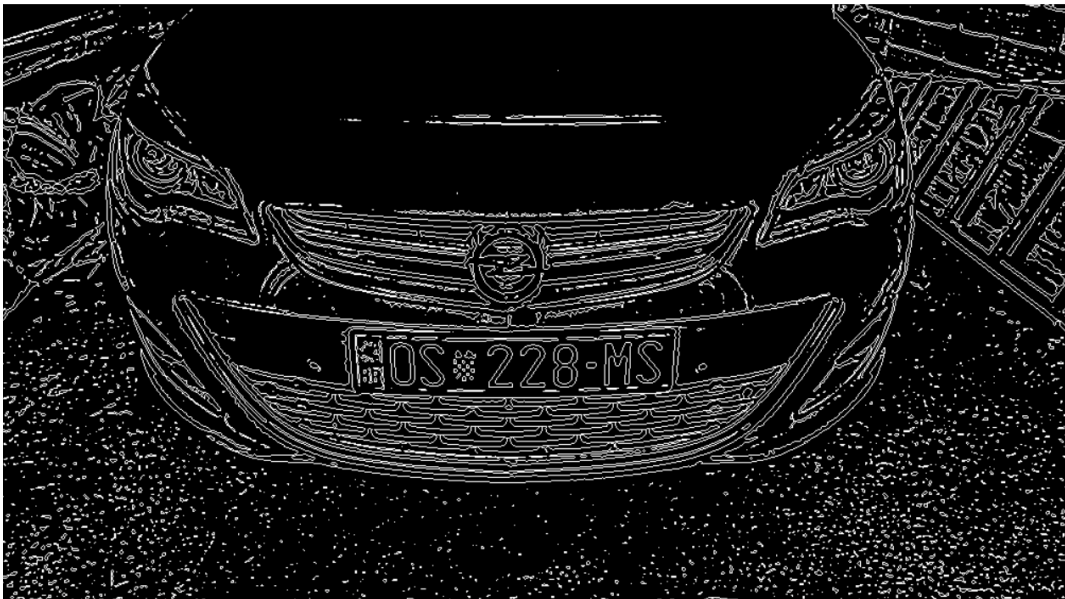
Slika 9. Osobni automobil – korak Adaptive threshold
