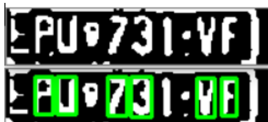
Slika 32. Segmentacija – gradski autobus
