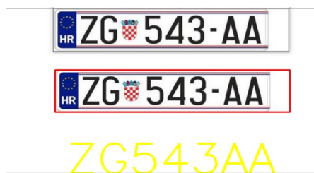
Slika 36. Ispravna detekcija – primjer samo sa tablicom
