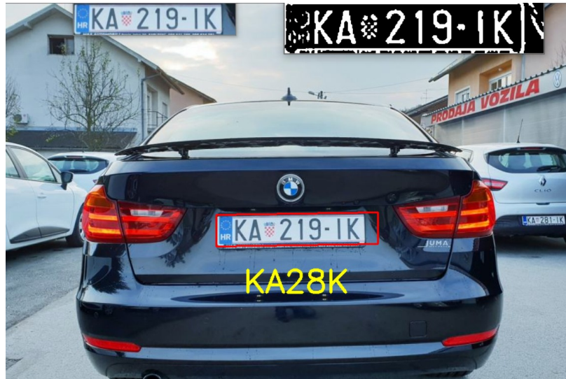
Slika 38. Djelomična detekcija – primjer 1
