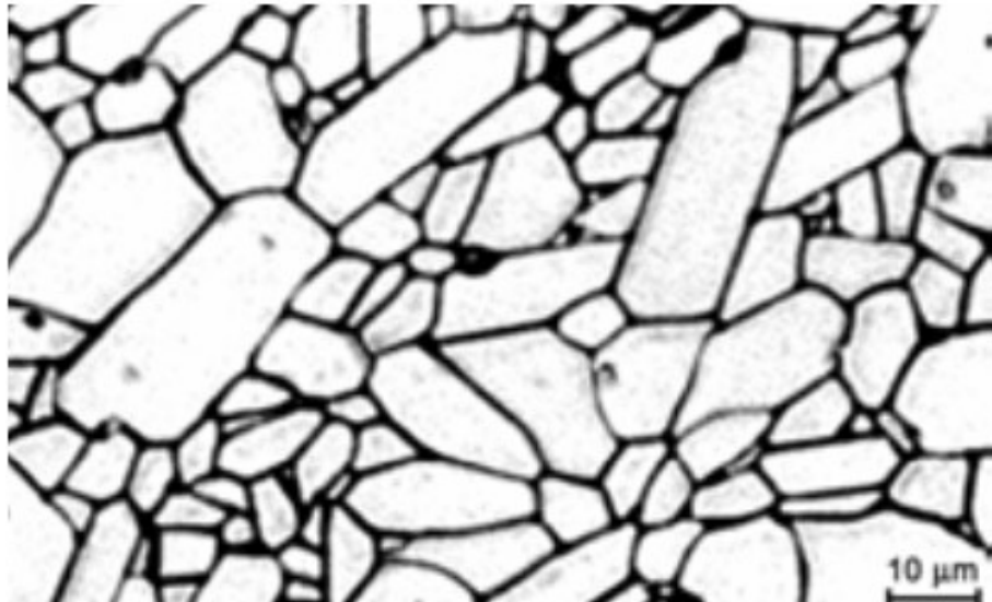
Slika 15. Prikaz strukture \text{Al}_2\text{O}_3 [9]
