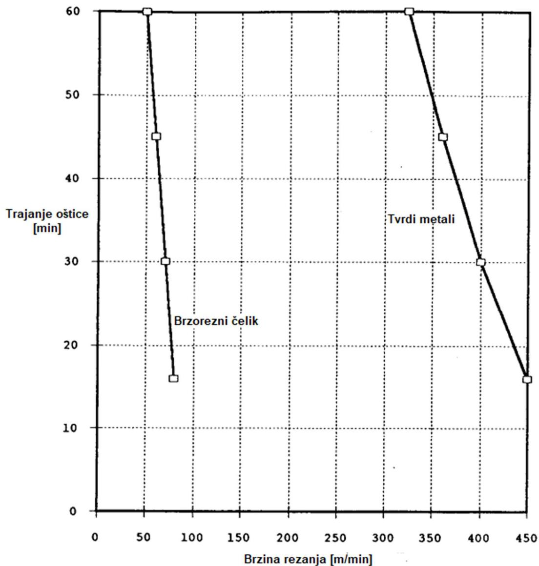
Slika 4. Usporedba trajanja oštice brzoreznog čelika i tvrdih metala [1]
