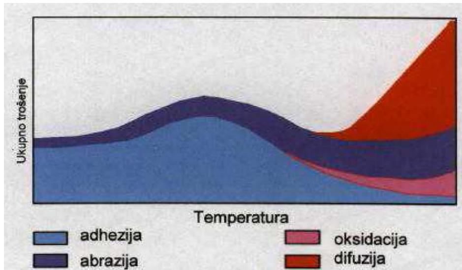
Slika 9. Prikaz zastupljenosti pojedinog trošenja alata ovisno o temperaturi [6]
