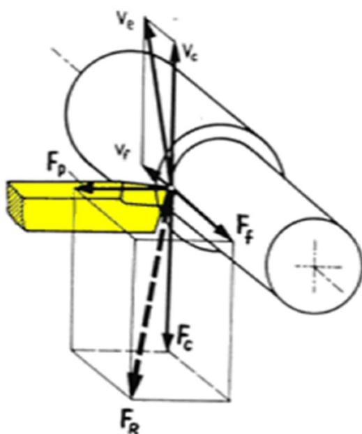
Slika 5. Sile i brzine rezanja kod tokarenja [4]
