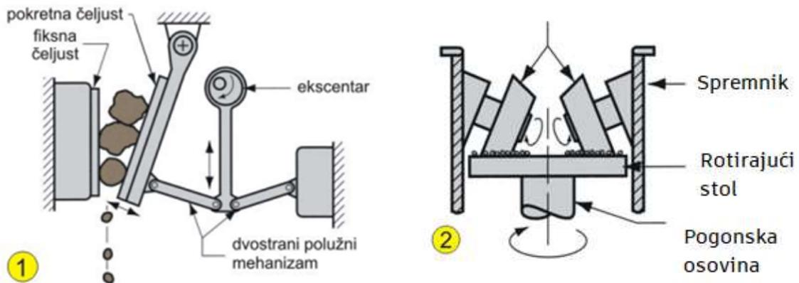
Slika 11. Prikaz postupaka usitnjavanja sirovine za pripravu keramičkog praha [8]
