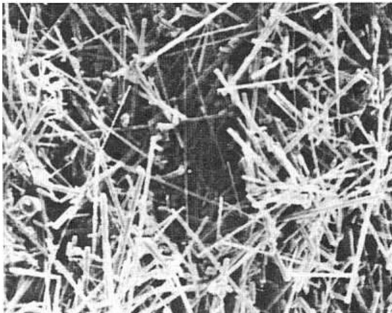
Slika 17. Prikaz vlakana za ojačavanje žilavosti u strukturi [1]
