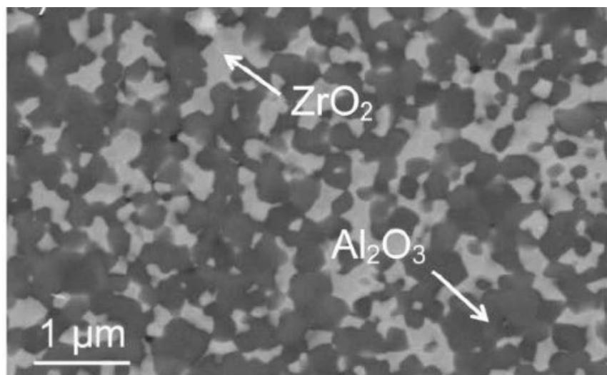
Slika 19. Prikaz mikrostrukture aluminijevog oksida ojačanog cirkonijevim oksidom [9]
