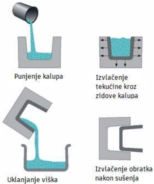
Slika 12. Prikaz postupka lijevanja u formu [8]
