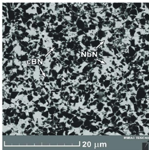
Slika 26. Prikaz mikrostrukture materijala sa 50% volumena CBN-a [11]
