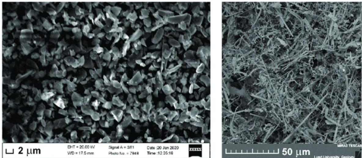
Slika 18. Prikaz mikrostrukture  $\text{Al}_2\text{O}_3$  ojačane s prahom (lijevo) i sa vlaknima (desno)
