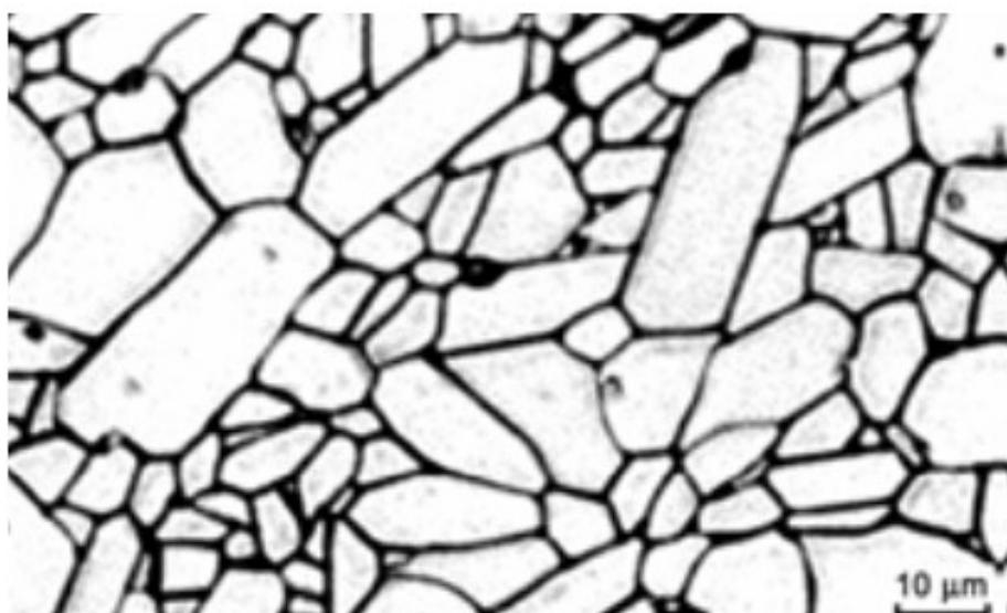
Slika 15. Prikaz strukture Al<sub>2</sub>O<sub>3</sub> [9]
