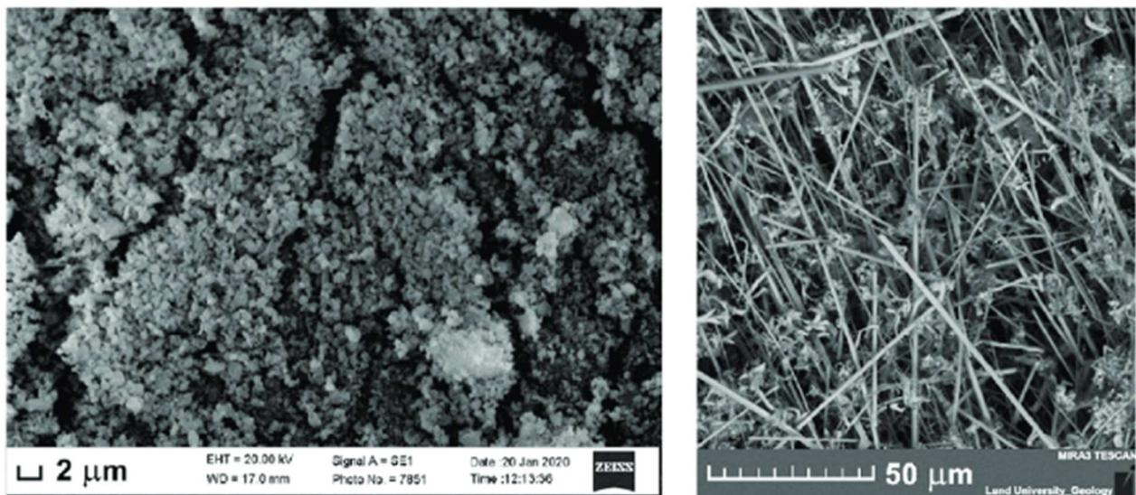
Slika 21. Prikaz mikrostrukture  $\text{Si}_3\text{N}_4$  ojačane sa prahom (lijevo) i sa vlknima (desno) [9]
