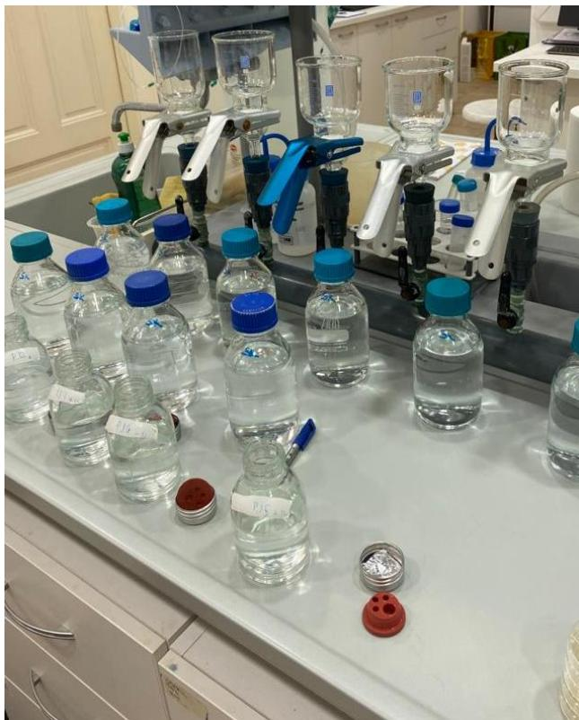
Slika 6. Oprema za filtraciju uzorka (Izvor: vlastita fotografija, 2022)
