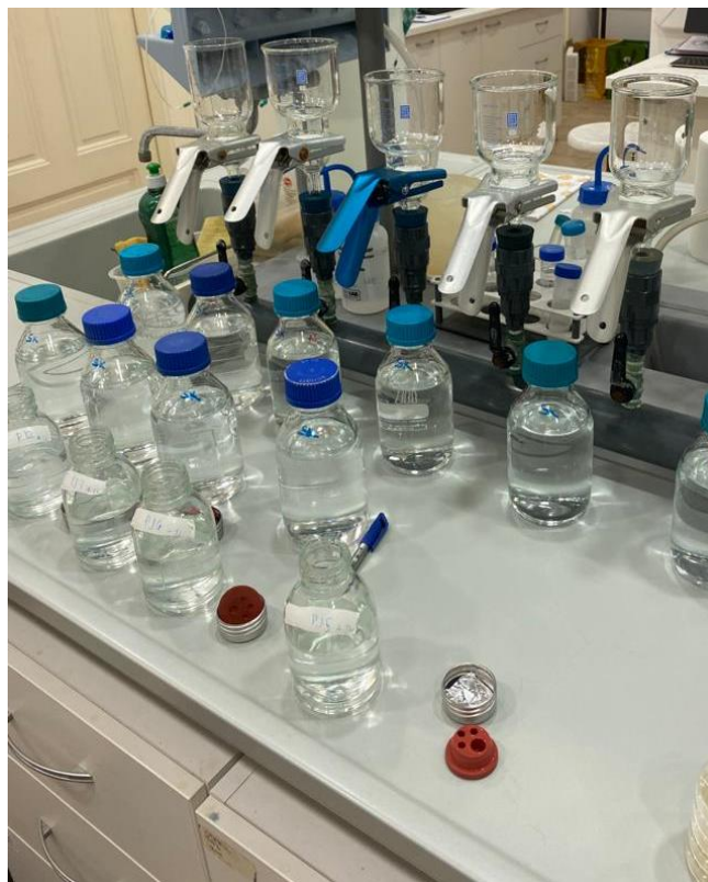
Slika 6. Oprema za filtraciju uzoraka (Izvor: vlastita fotografija, 2022)
