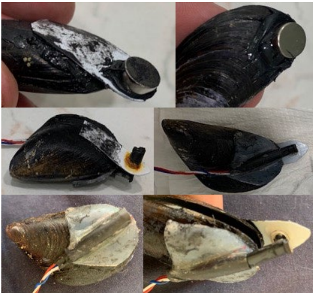
Slika 9. Različiti načini pričvršćivanja senzora i magneta na ljušturu dagnji.
