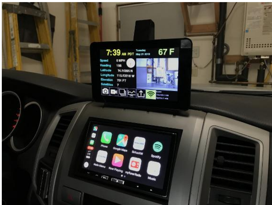
Slika 13 - Carputer kodiran u Pythonu-u baziran na Raspberry Pi, ugrađeno u Toyota (izvor: https://github.com/jbuehl/carputer )
