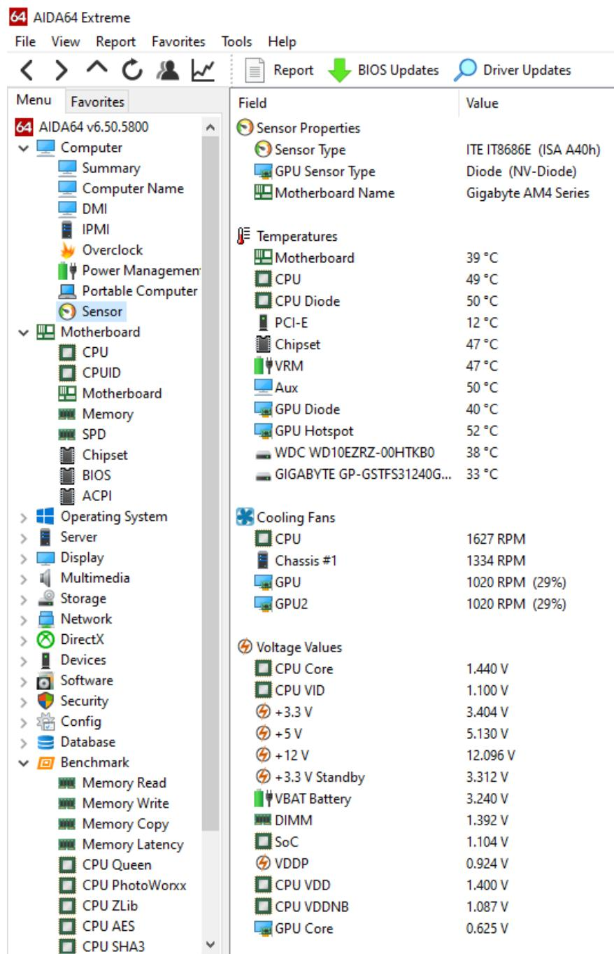
Slika 11. Sučelje za praćenje temperatura CPU-a pomoću „Senzor“ alata
