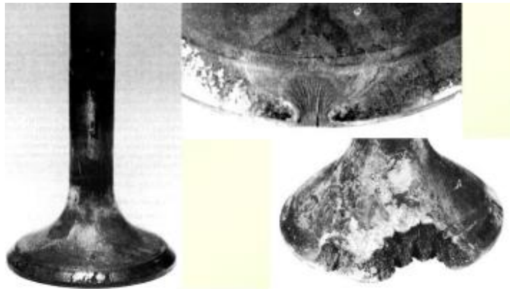
Slika 1: Oštećenje ventila uzrokovano kemijskom korozijom [11]
