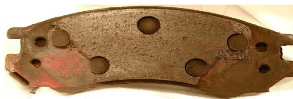
Slika 8: Tarna korozija automobilske kočnice [27]
