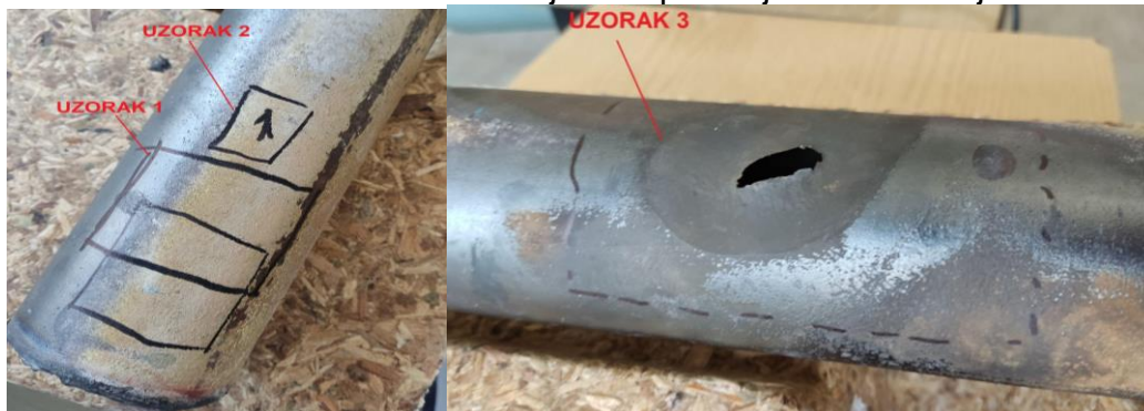
Slika 15: Plan uzorkovanja za ispitivanje u laboratoriju
