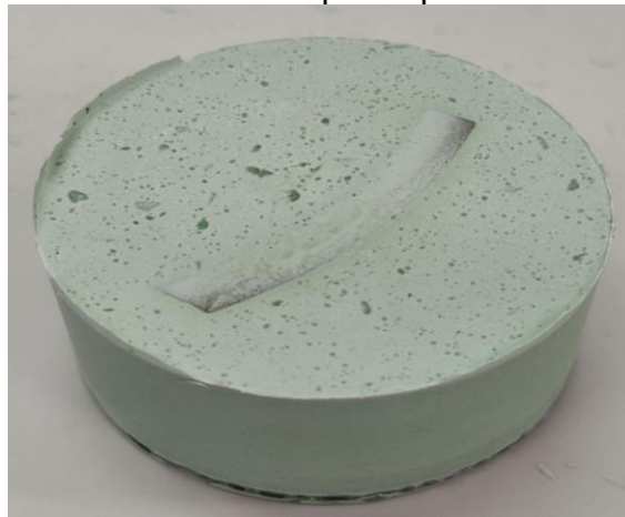
Slika 38: Uzorak 2 u kalupu od poliesterske smole
