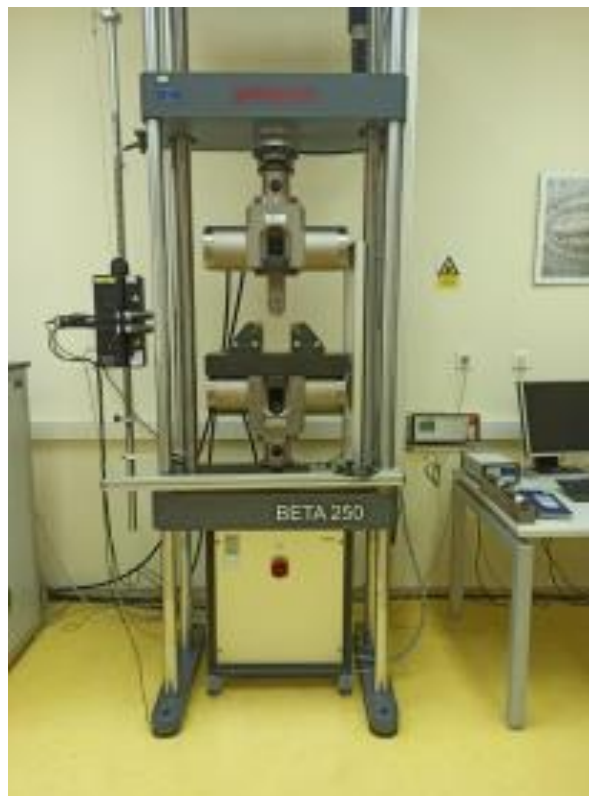
Slika 17: Univerzalna statička kidalica MESSPHYSIK BETA 250
