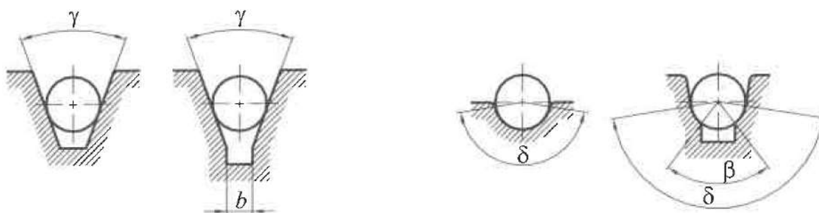
Slika 15. Lijevo - kut \gamma za klinasti žlijeb, desno - kutevi \beta i \delta za kružni žlijeb
