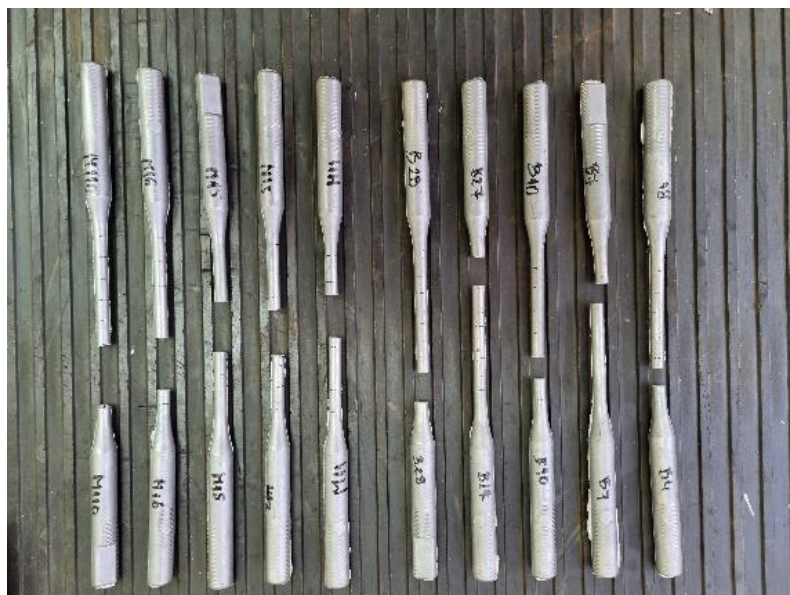
Slika 25: Testne epruvete nanokompozita nakon vlačnog testa
