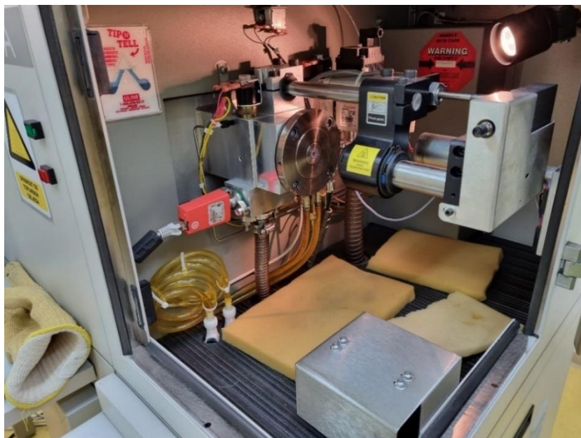
Slika 38: Unutrašnjost GDS uređaja Leco tip 500A
