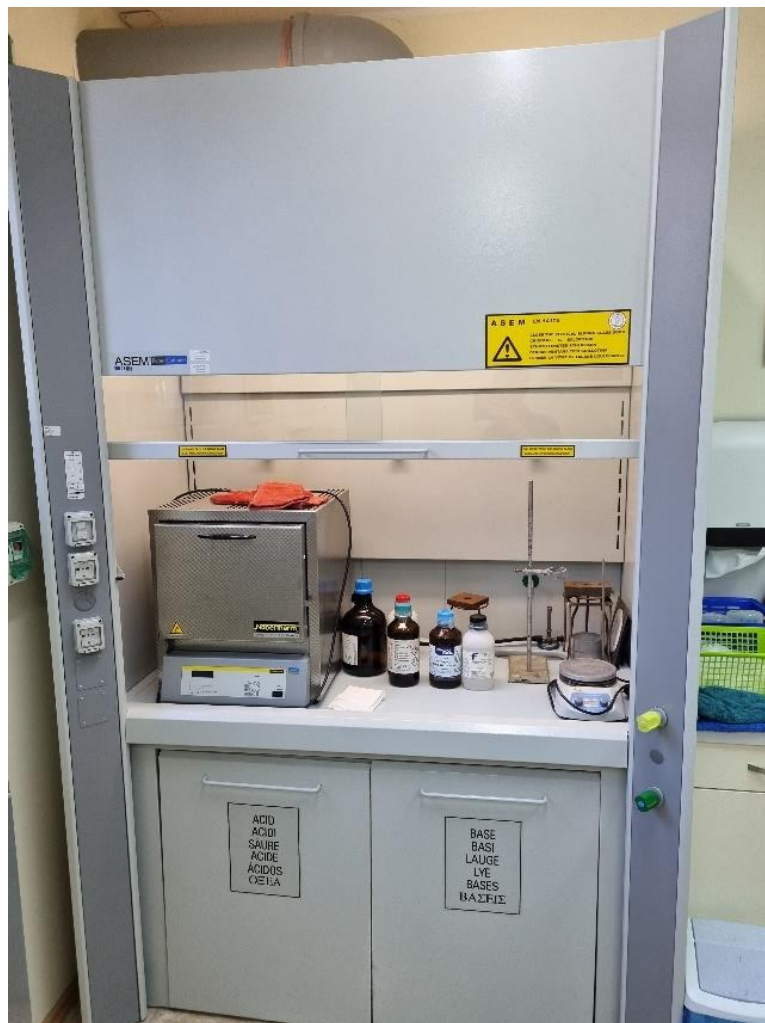
Slika 33: Digestor s kemikalijama korištenim u izradi Kellerovog reagensa
