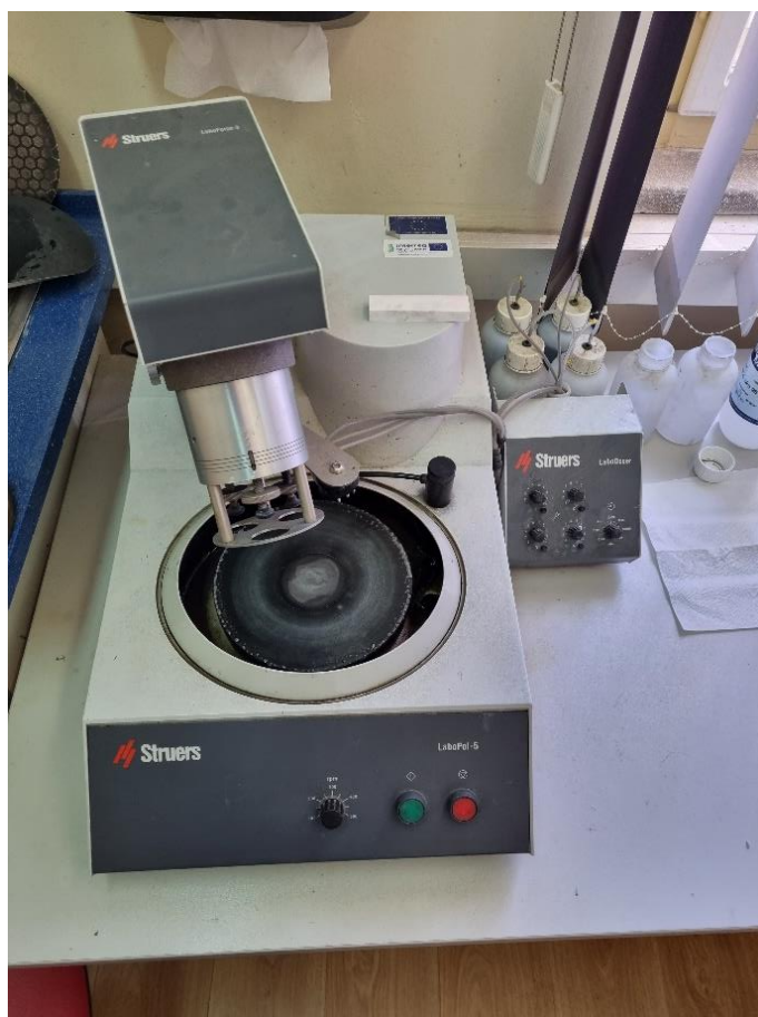
Slika 31: Struers Labopol - 5 uređaj za brušenje i poliranje
