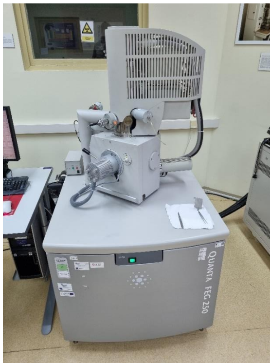
Slika 42: FEI Quanta 250 FEG SEM instrument
