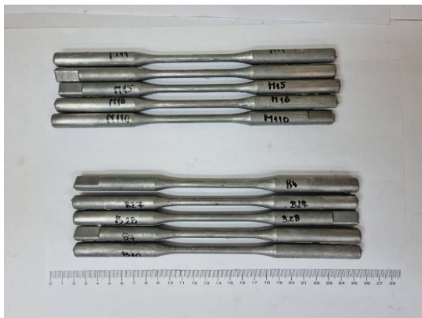
Slika 21: Testne epruvete nanokompozita
