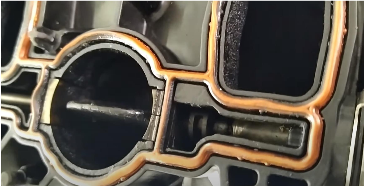
Slika 48: Prikaz ispravnog položaja zaklopki (kut od 90°)
