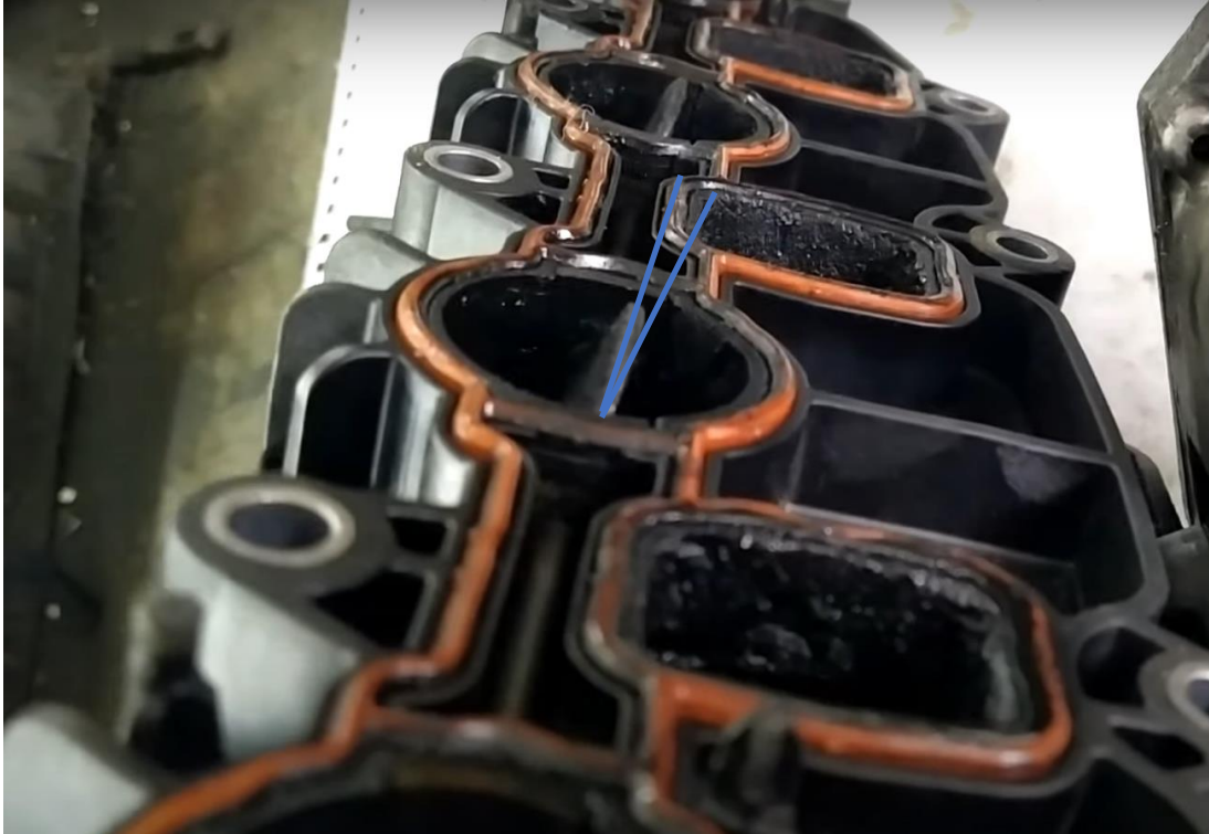
Slika 42: Krivi položaj zaklopki - zaklopke se zatvaraju "padaju" za nekoliko stupnjeva
