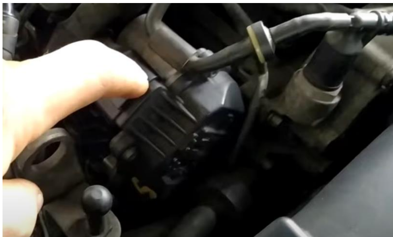
Slika 37: Elektromotor unutar kojeg se nalazi senzor položaja
