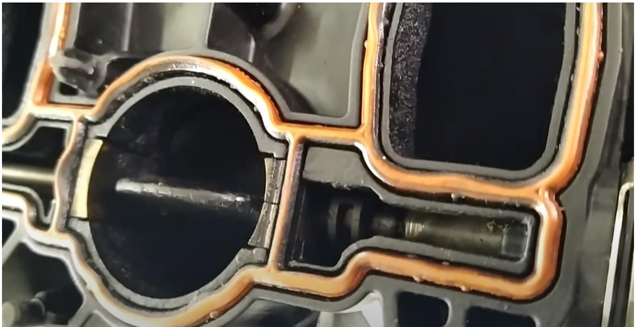
Slika 48: Prikaz ispravnog položaja zaklopki (kut od 90°)
