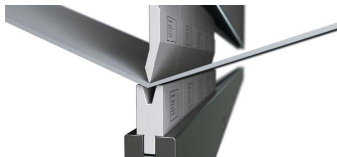
*Slika 15 Zračno savijanje lima; izvor: <https://www.laser-ing.hr/wp-content/uploads/2022/07/savijanje-lima.jpg>*
