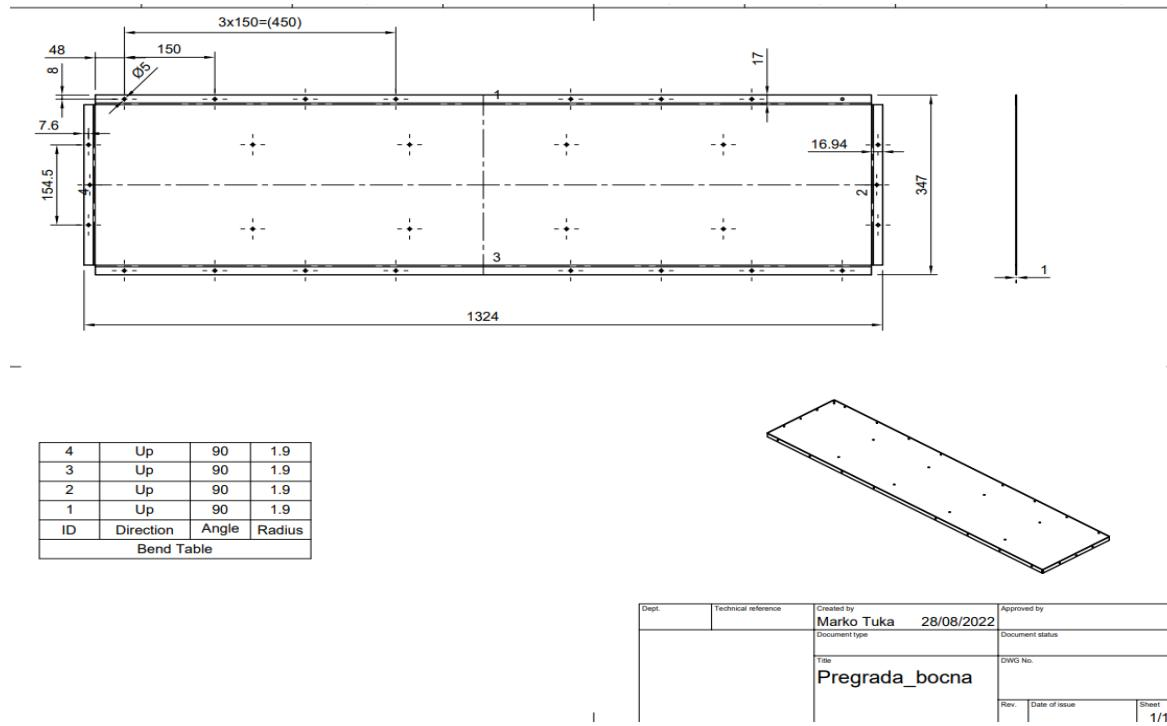
Slika 22 Tehnički crtež - otvoren plašt; izvor: izrada autora
