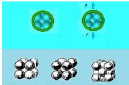
Slika 3 Kristalna građa i promjene položaja atoma u kristalnoj rešetci uslijed deformacije; izvor: Stojan Rešković, Osnove teorije oblikovanja deformiranjem, str.5
