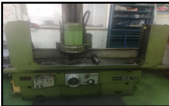
Slika 29.: Stroj za obradu baze bloka motora
