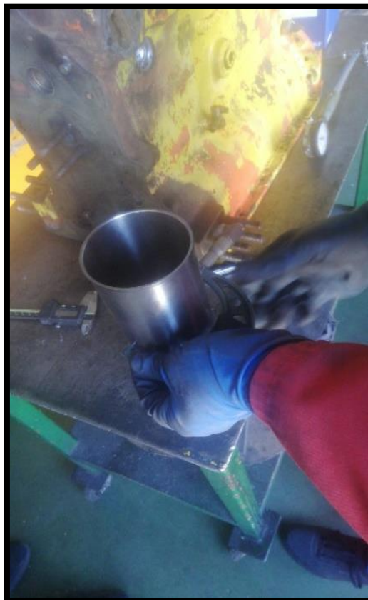
Slika 25.: Mjerenje mjernim mikrometrom vanjskog promjera košuljice
