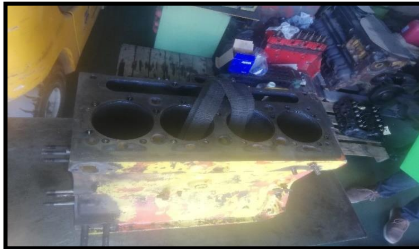
Slika 19.: Skinuti blok motora
