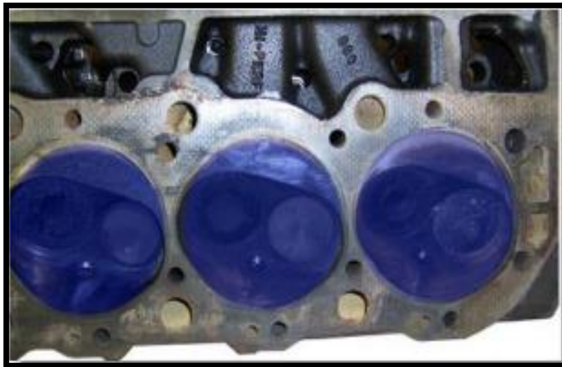
Slika 3.: Komora za sagorijevanje
