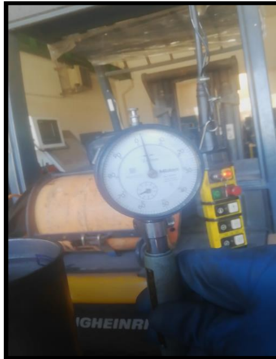
Slika 28.: Izmjereni preklop košuljice i bloka motora 0,03 mm
