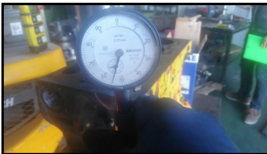
Slika 23.: Izmjereno treće odstupanje istrošenosti cilindra 0,45 mm
