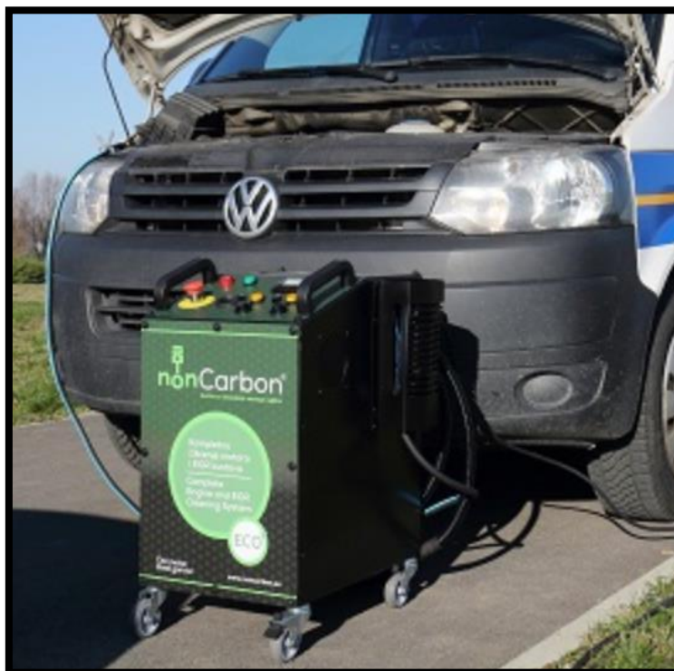
Slika 15.: nonCarbon uređaj za dekarbonizaciju
