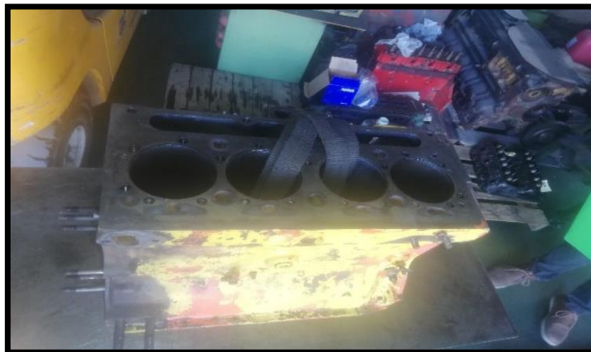
Slika 19.: Skinuti blok motora
