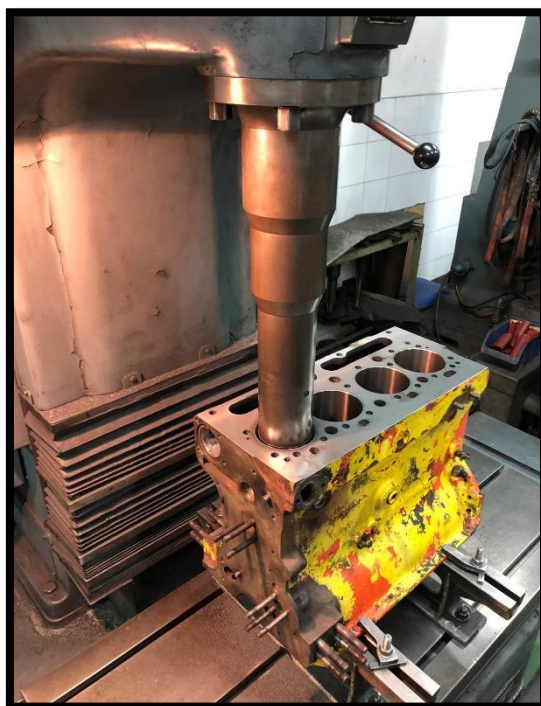
Slika 32.: Ulaz glave tokarilice u košuljicu cilindra
