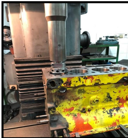
Slika 30.: Izravната baza bloka motora i cilindri spremni za tokarenje
