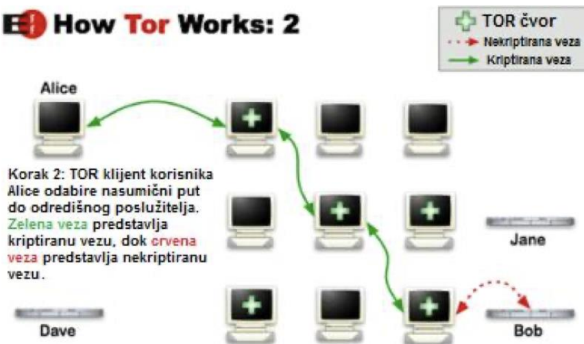
Slika 18. Način rada TOR-a, 2. korak (cis.hr, 2012.).
