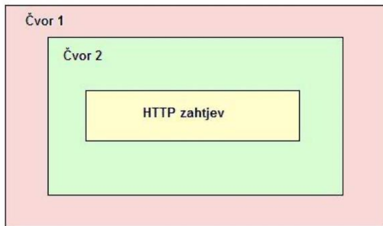
Slika 13. Struktura poruke sa HTTP zahtjevom.
