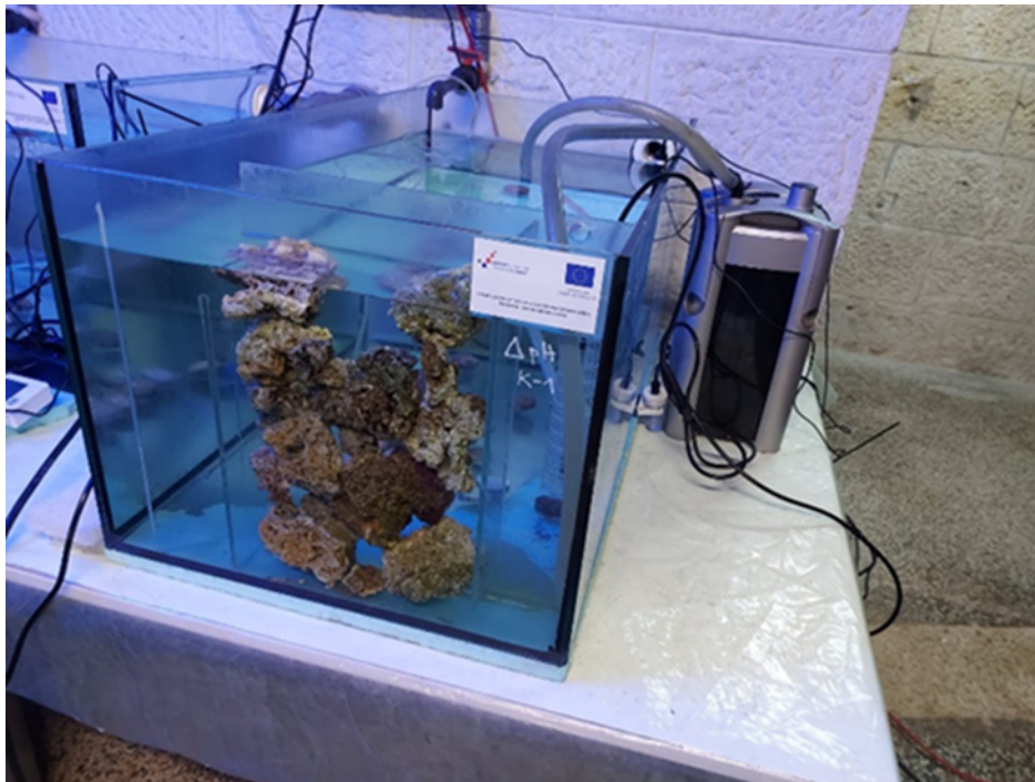
Slika 6. Bazen s postavljenim uvjetima za ispitivanje utjecaja promjene pH na rast češljače.
