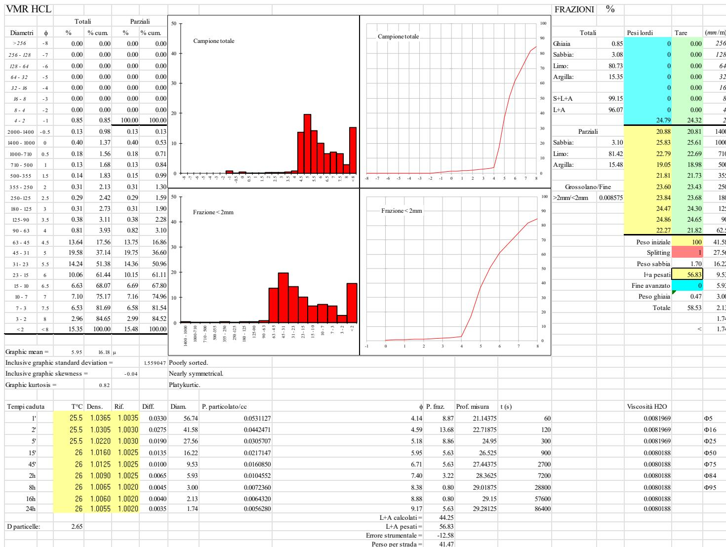
Slika 26-prikaz rezultata granulometrijske analize uzorka tretiranog sa HCL-om
