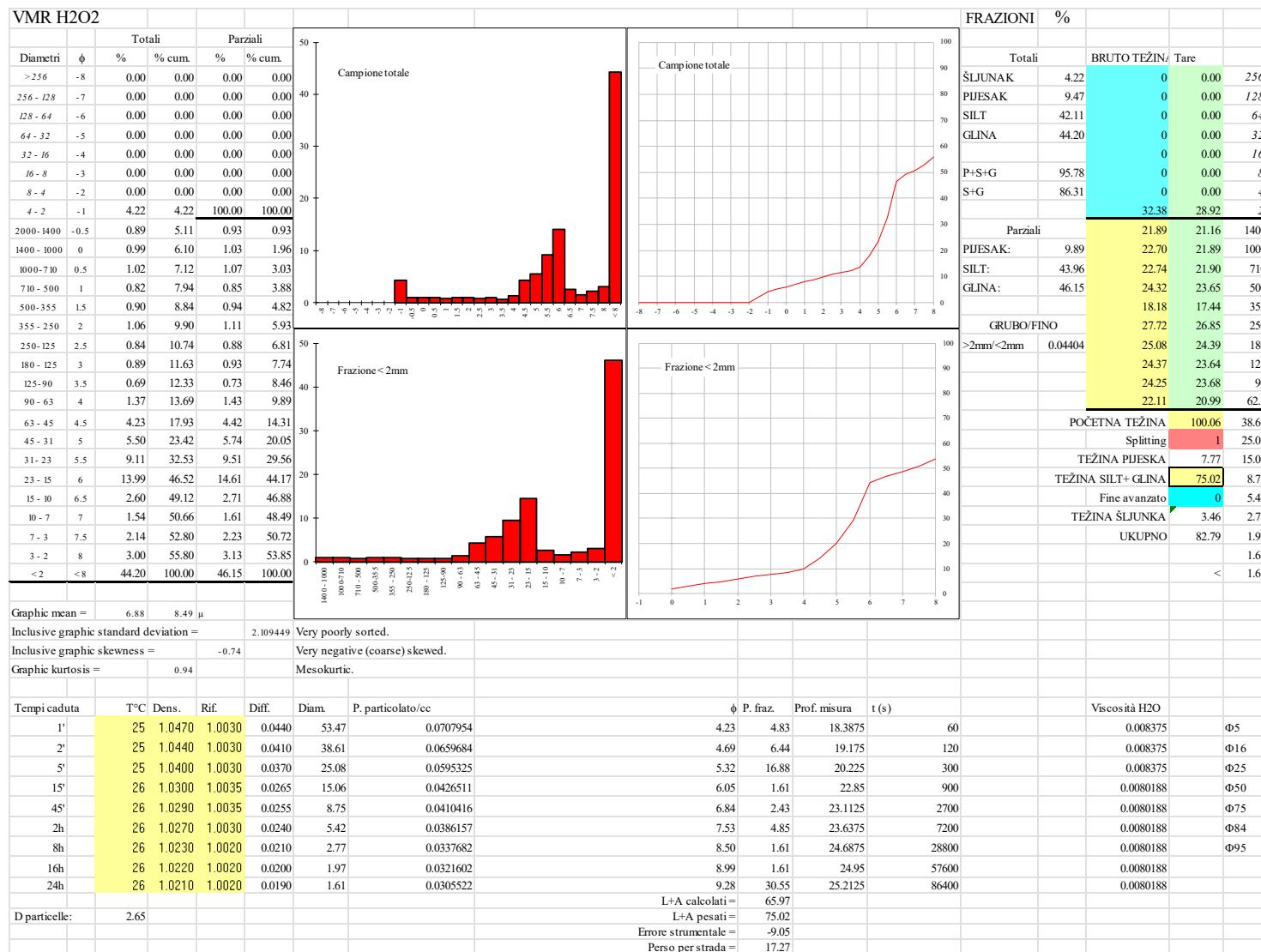
Slika 25-Prikaz rezultata granulometrijske analize uzorka tretiranog sa H2O2-om
