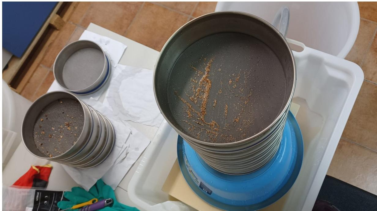
Slika 4-prosijavanje uzorka tretiranog H<sub>2</sub>O<sub>2</sub>-om
