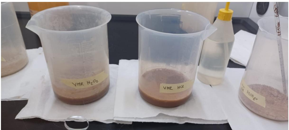
Slika 2-Uzorci tla SJ 4 istočnog profila sonde II u digestoru nakon tretiranja sa HCl i H<sub>2</sub>O<sub>2</sub>
