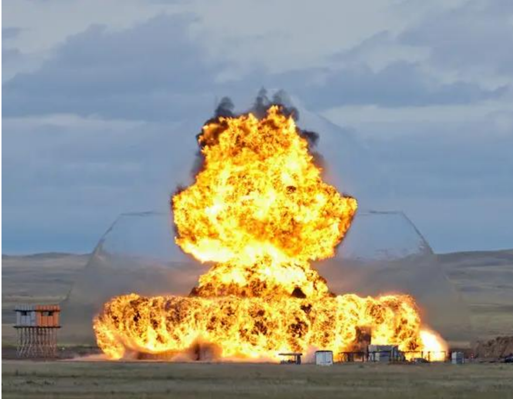
Slika 10. Prikaz detonacije eksploziva. Vidljiva je udarna fronta koja prethodi fronti izgaranja.
