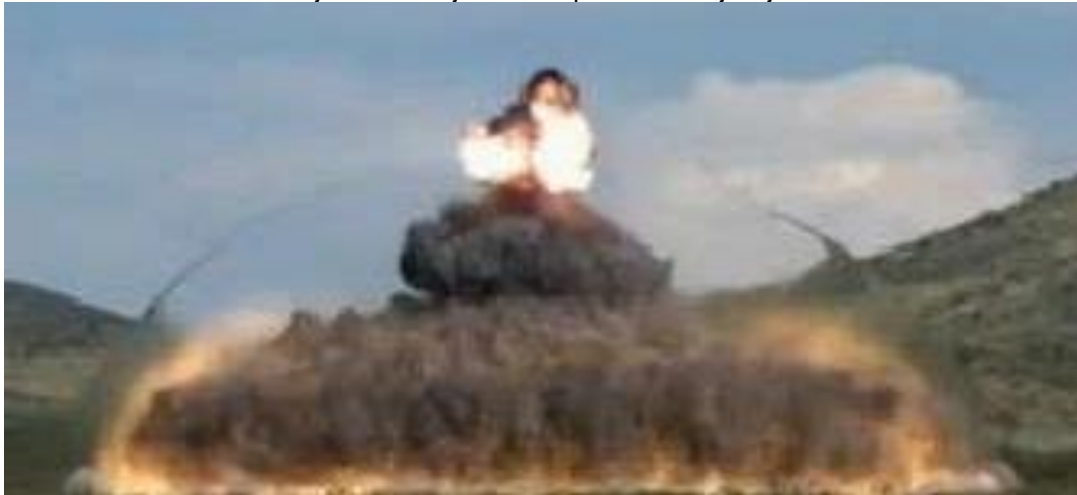
Slika 2. Primjer detonacije kod eksploziva - vidljiva je udarna fronta vala.
