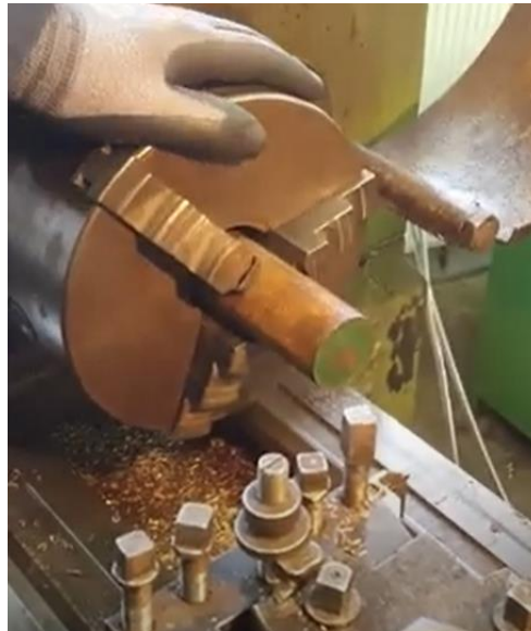
Slika 31. Obradak umetnut u steznu glavu
