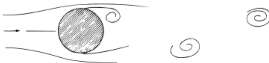
Slika 5.4: Pojava vrtloženja uslijed morskih struja [7]
