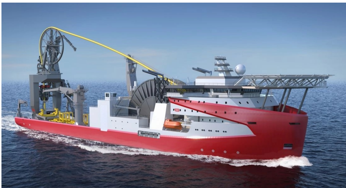
Slika 2.4: Prikaz barže za reel-lay instalaciju [14]
