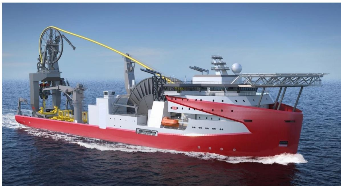
Slika 2.4: Prikaz barže za reel-lay instalaciju [14]
