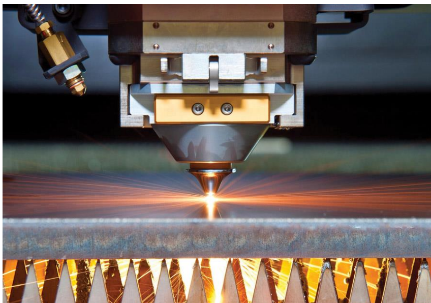
Slika 5 Lasersko rezanje pomoću CO 2
