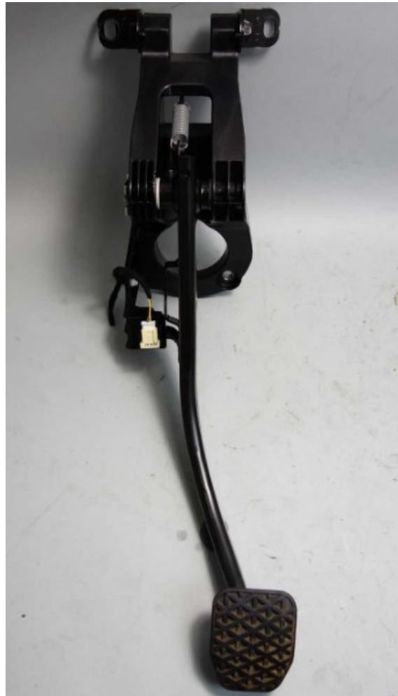
Slika 54: Izvedba pedale kočnice za cestovne automobile - 2
