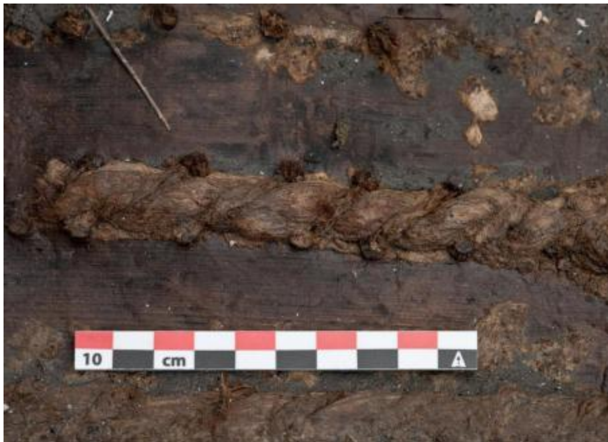
Slika 5: Pula 2: detalj spajanja šivanjem, sliku ustupila I. Koncani Uhač
