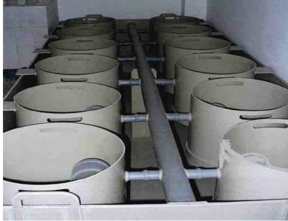
Slika 10. Upwelling sustav za uzgoj mrladi (Gavrilović i sur., 2021).
