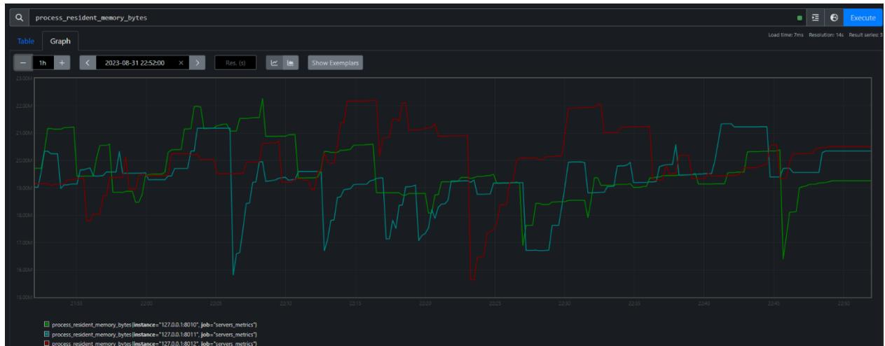
*Slika 27: Ponašanje fizičke memorije u Nginx raspoređivaču prometa*
