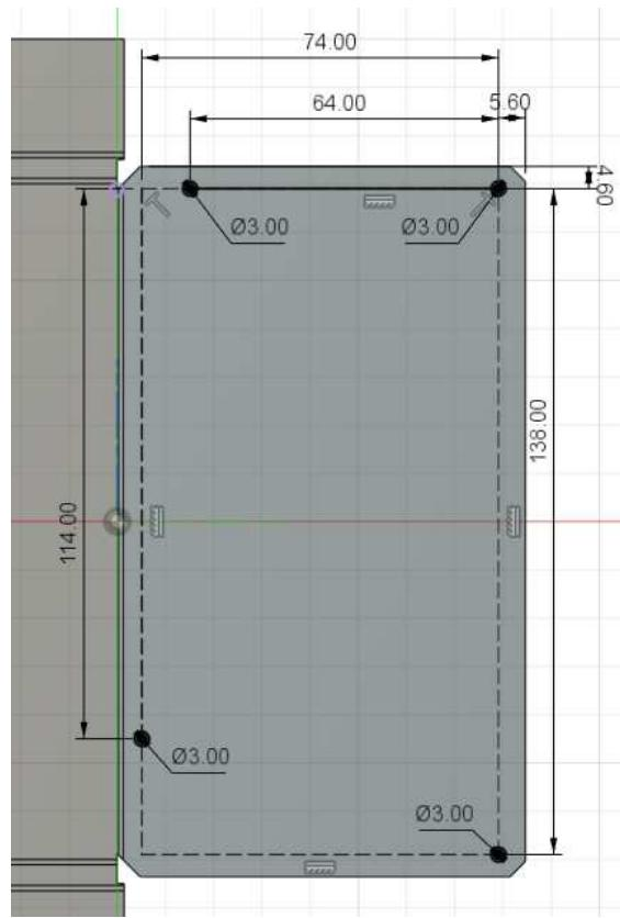
Slika 40 Raspored rupa kod ATX PS/2 standarda napajanja
