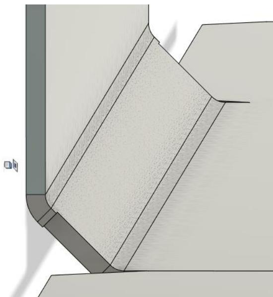
Slika 38 Dva savijanja od 45 stupnjeva na bočnoj strani
