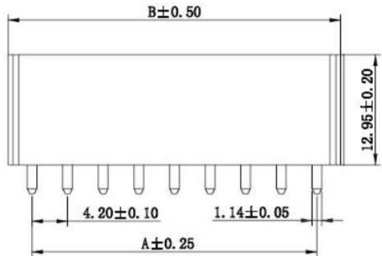
Slika 45 dimenzije ATX konektora
