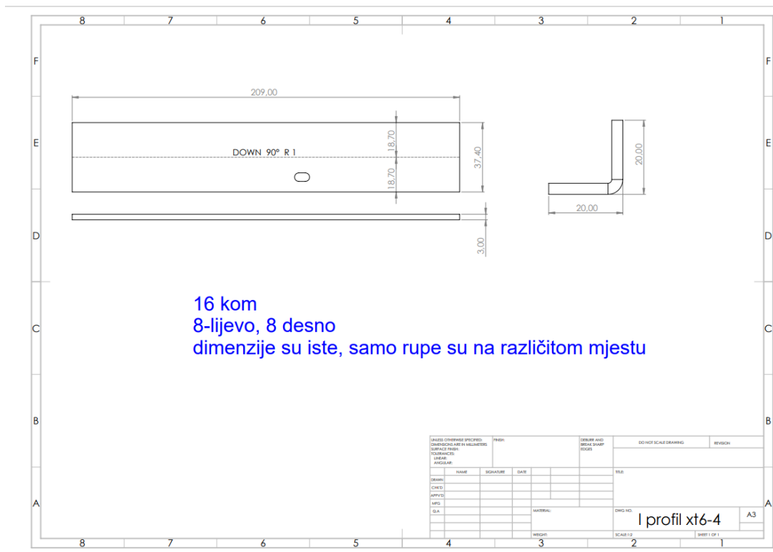
Slika 57 Radionički nacrt savijanja nosača ploče
