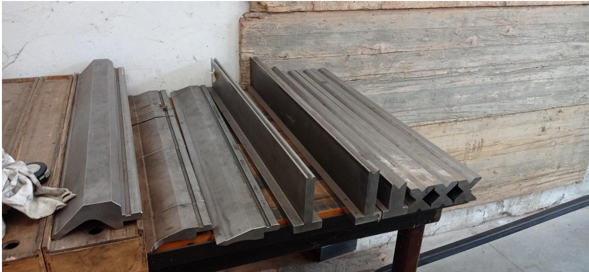
Slika 21 Prizme i noževi za savijanje
