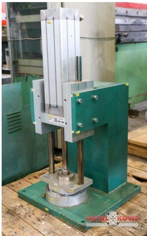
Slika 8. Zračna preša - Izvor: ("www.metal-kovis.hr", 2023.)
