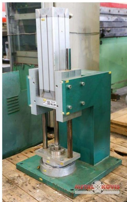
Slika 8. Zračna preša - Izvor: ("www.metal-kovis.hr", 2023.)
