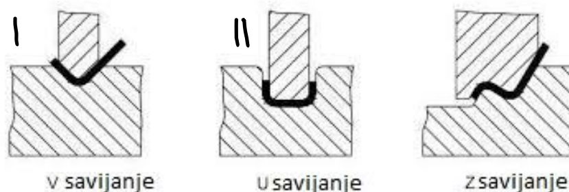
Slika 4. Primjeri savijanja u kalupima - Izvor: ("Sheet metal bending: Everything you should know explained", Shane Zang, www.machinemfg.com , 2023.)
