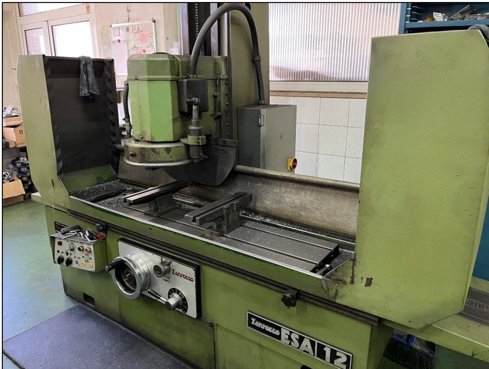
Slika 24. Stroj korišten za ravnanje bloka Zanrosso ESA 12.
