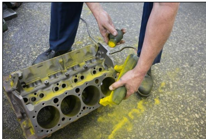
Slika 8. Praktičan primjer magnetne detekcije
