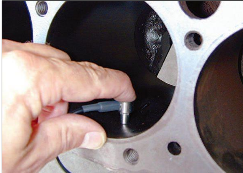
Slika 10. Praktički primjer ultrazvučne detekcije.
