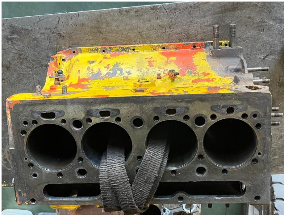
Slika 14. Goli blok motora Perkins D 4.203.
