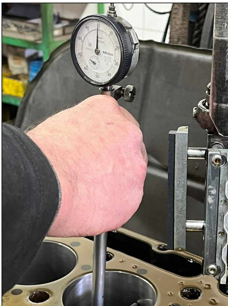
Slika 33. Mjerenje finalne obrade štapnom mjernom urom.
