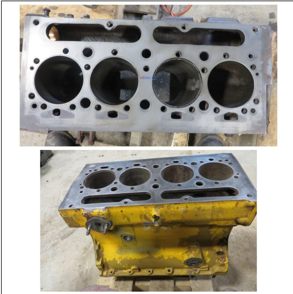
Slika 5. Primjer golog bloka motora Perkins D 4.203
