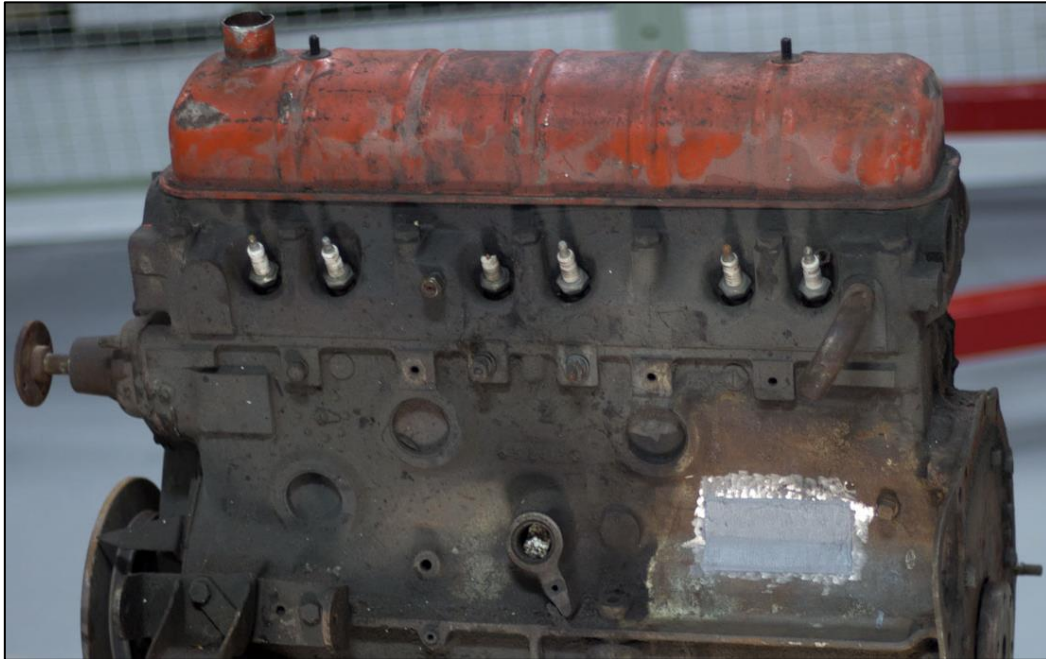
Slika 12. Primjer reparacija bloka motora metodom zavarivanja.
