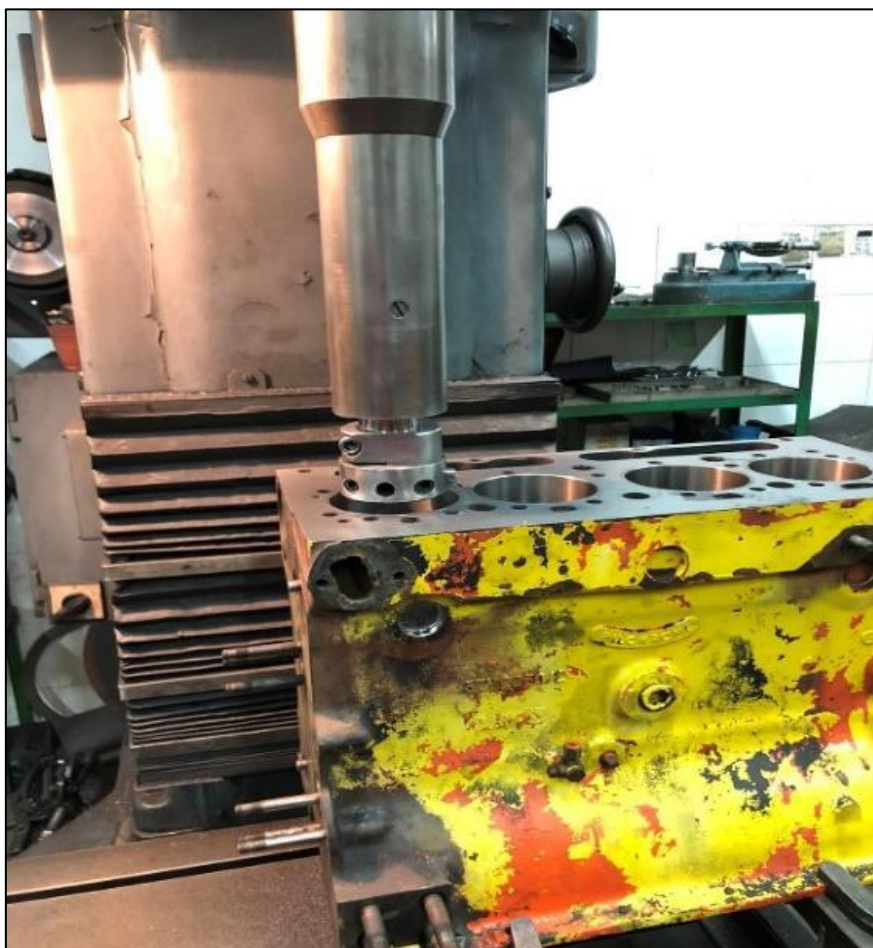
Slika 25. Poravnata baza bloka motora sa novo prešanim košuljicama.
