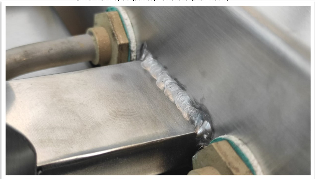
Slika 18. Izgled punog zavara u proizvodnji
