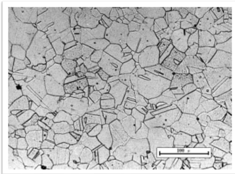
Slika 4. Mikrostruktura austenitnog nehrđajućeg čelika
