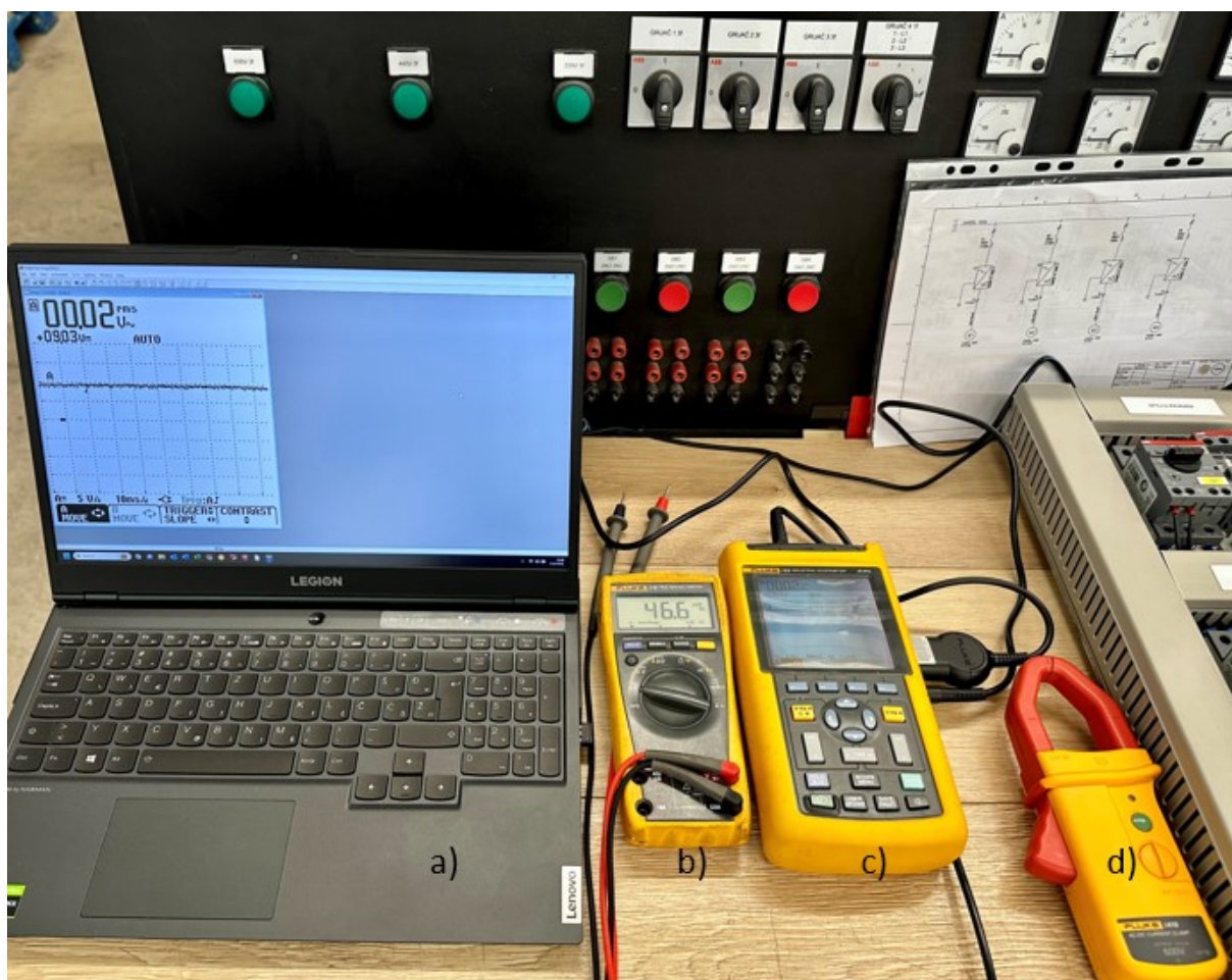
Slika 44. Mjerna oprema: a) prijenosno računalo b) Fluke 179, c) Fluke 123, d) Fluke i410 [Autor]
