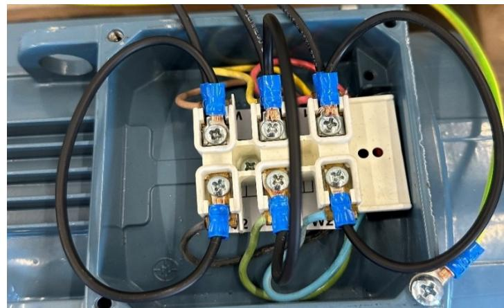
Slika 49. *Spojna kutija motora spojenog u trokut* [Autor]
