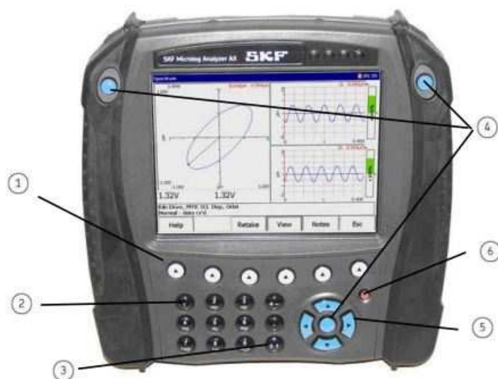
Slika 5.4 SKF Microlog Analyzer AX vanjska jedinica za obradu signala
