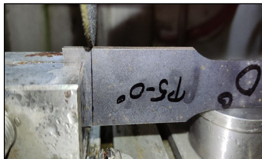
Slika 6. Uvećan pogled rezanja uzorka.
