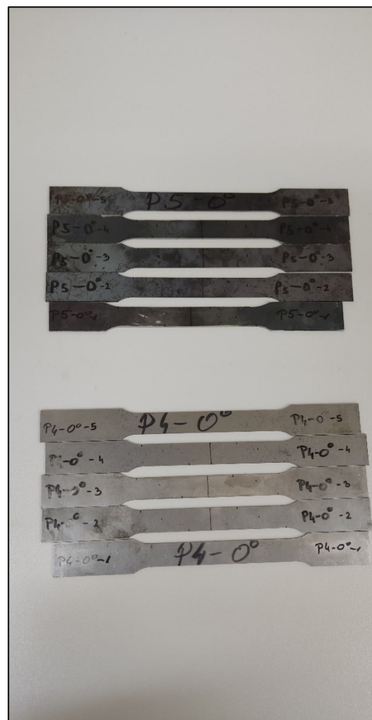
Slika 14. Ispitne epruvete P4 i P5.
