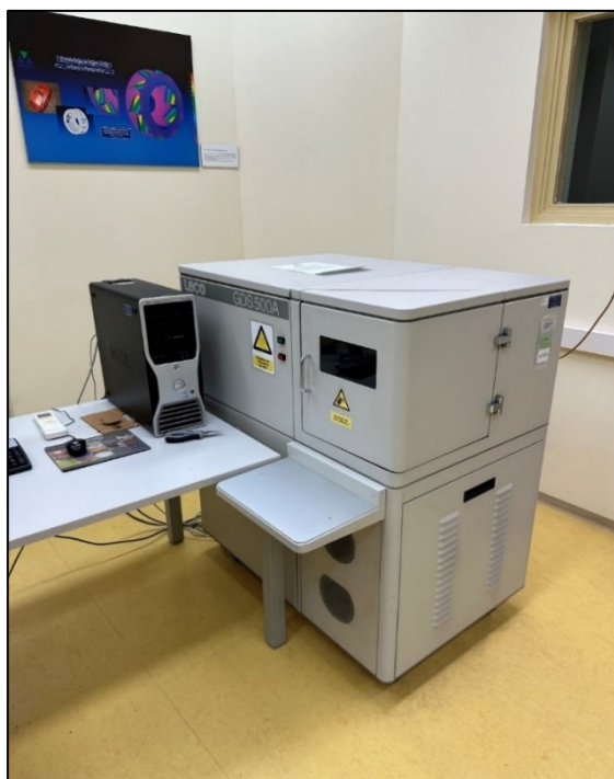
Slika 2. Spektrometar GDS500A tvrtke LECO.
