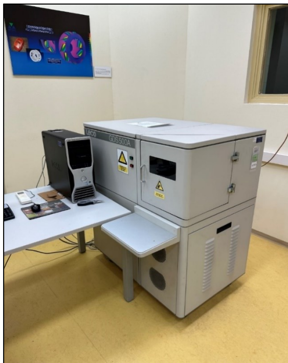
Slika 2. Spektrometar GDS500A tvrtke LECO.
