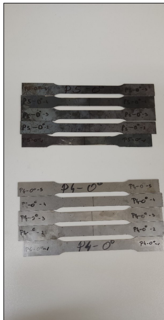
Slika 14. Ispitne epruvete P4 i P5.
