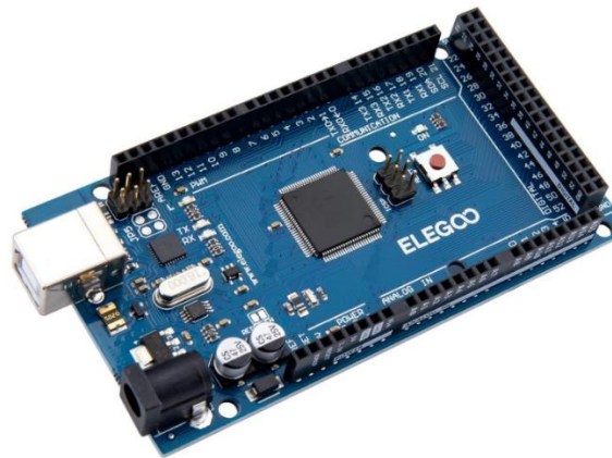
Slika 74. Mikrokontrolerska ploča ELEGOO Mega R3 Izvor: ELEGOO
