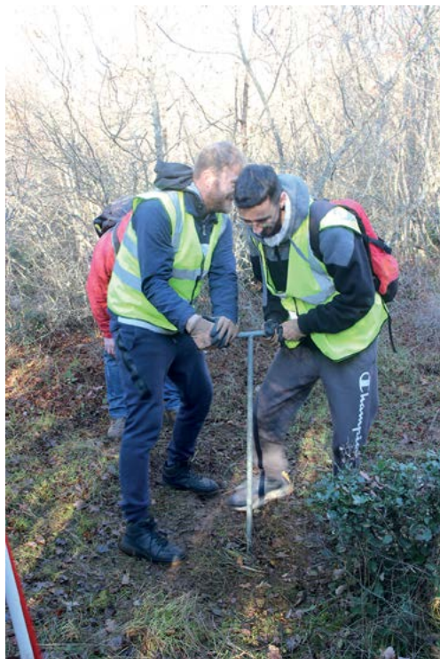
Slika 136: Sondiranje tla ručnim svrdlom.
