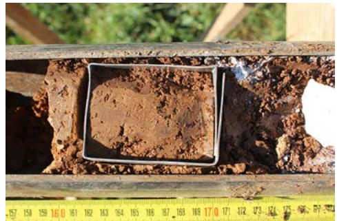
Slika 138b: Uzorkovanje za mikromorfološku analizu uz pomoć metalne kutije.
