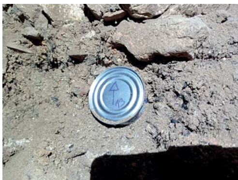
Slika 93b: Uzorak za mikromorfološku analizu prikupljen kutijom.
