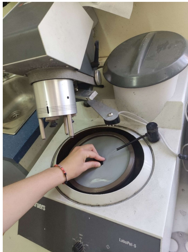
Slika 36: Poliranje materijala za ispitivanje tvrdoće
