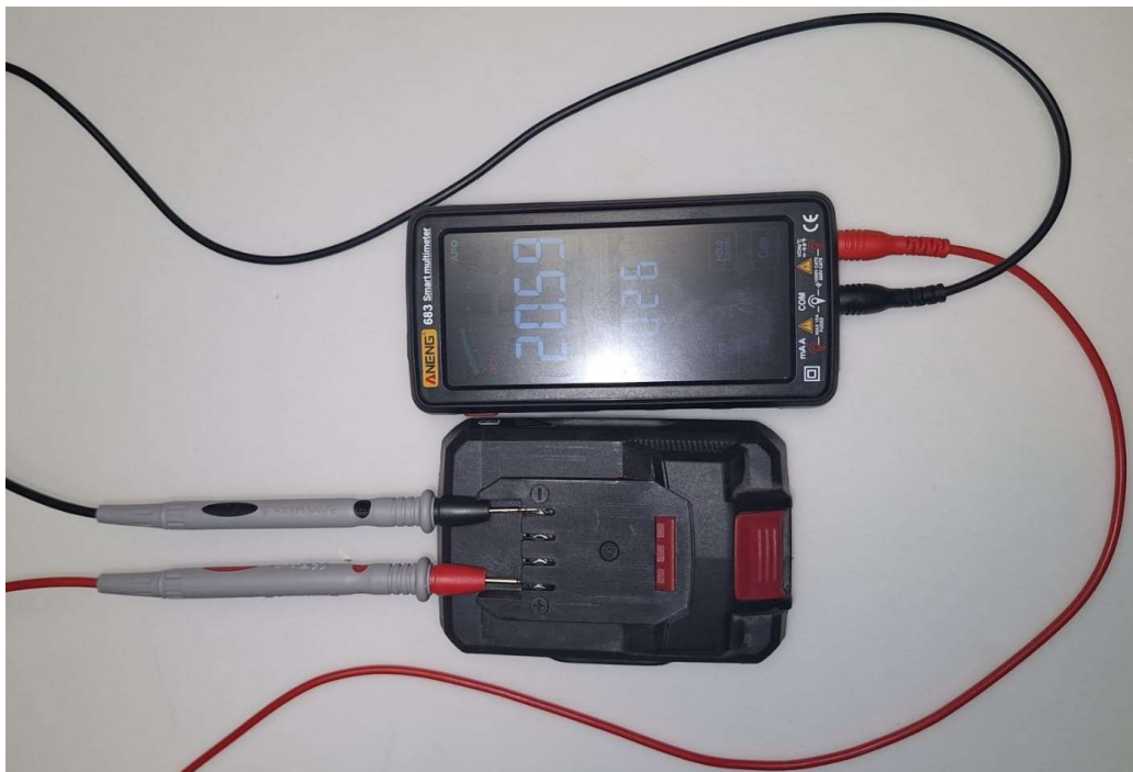
Slika 65: Multimetar u direktnom kontaktu s baterijom
