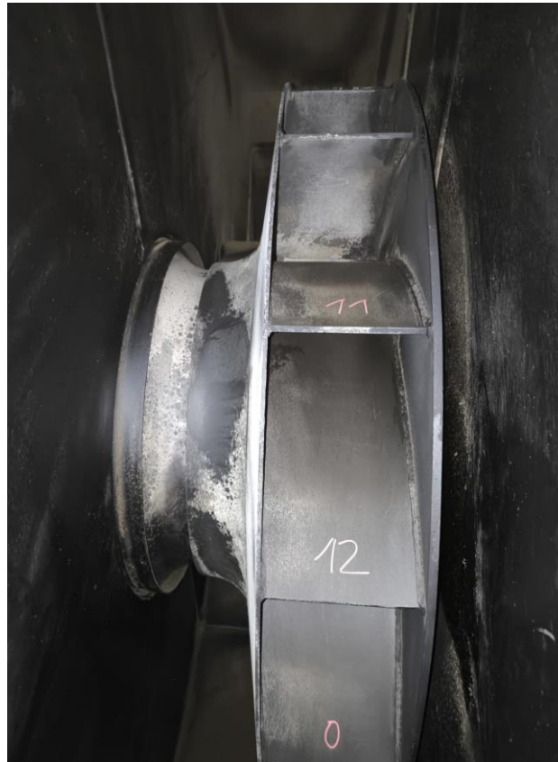
Slika 6.6. Označavanje lopatica impelera
