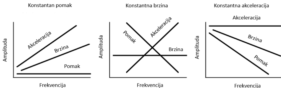
Slika 4.1. Odnos između pomaka, brzine i akceleracije [6]
