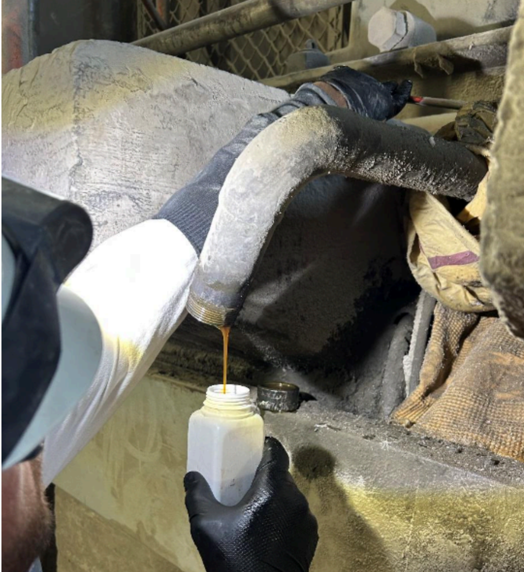
Slika 4.3.2.1. Postupak uzimanja ulja [9]
