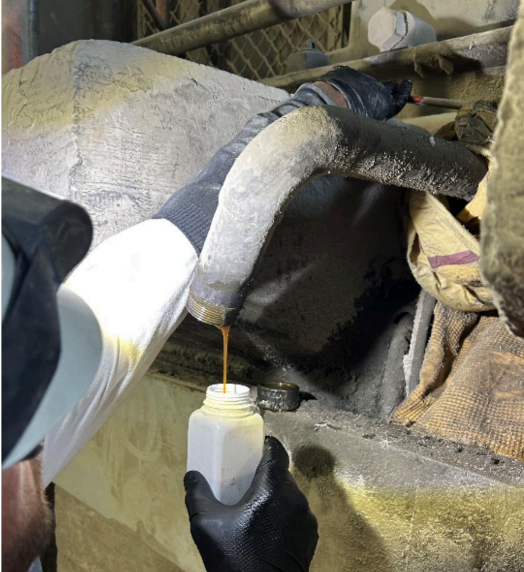
Slika 4.3.2.1. Postupak uzimanja ulja [9]
