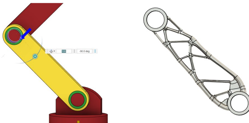
Slika 44 Generativni dizajn robotske ruke 3/4
