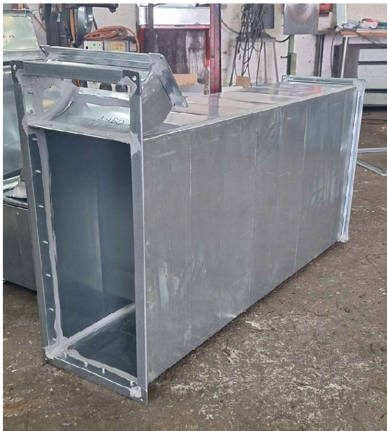
Slika 18 Montirana konstrukcija ventilacijskog odvoda
