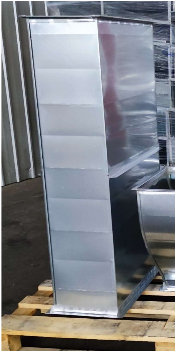
Slika 5 Ventilacijski kanal iz pocinčanog lima
