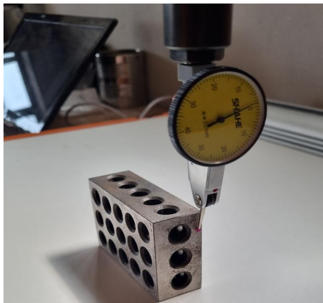
Slika 11 Mjerenje okomitosti Z osi u odnosu na X-Y
