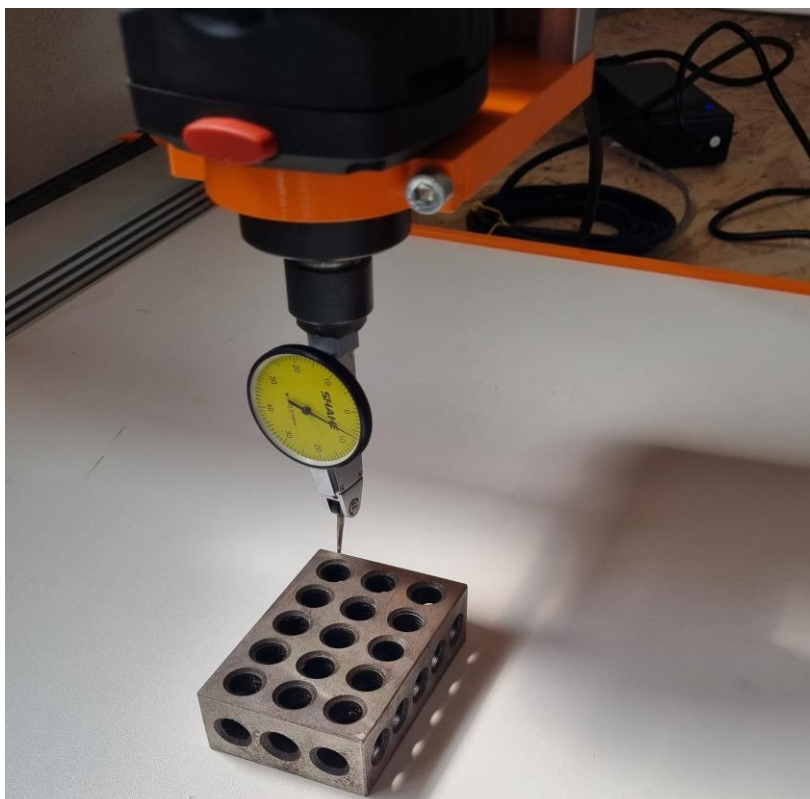
Slika 10 Mjerenje okomitosti X-Y osi
