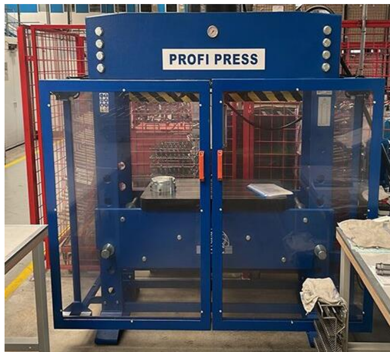
Slika 18. Zaštitna pregrada na preši
