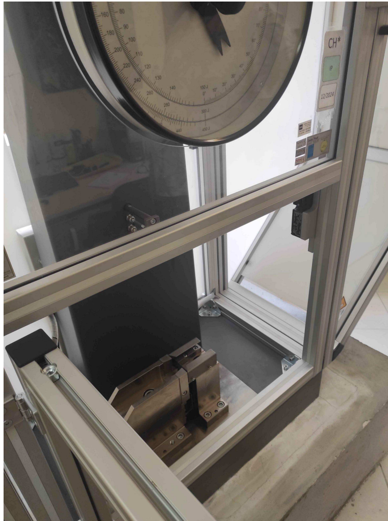
Slika 25: Unutrašnjost ZWICK ROELL RKP450 Charpy-jevog klatna
