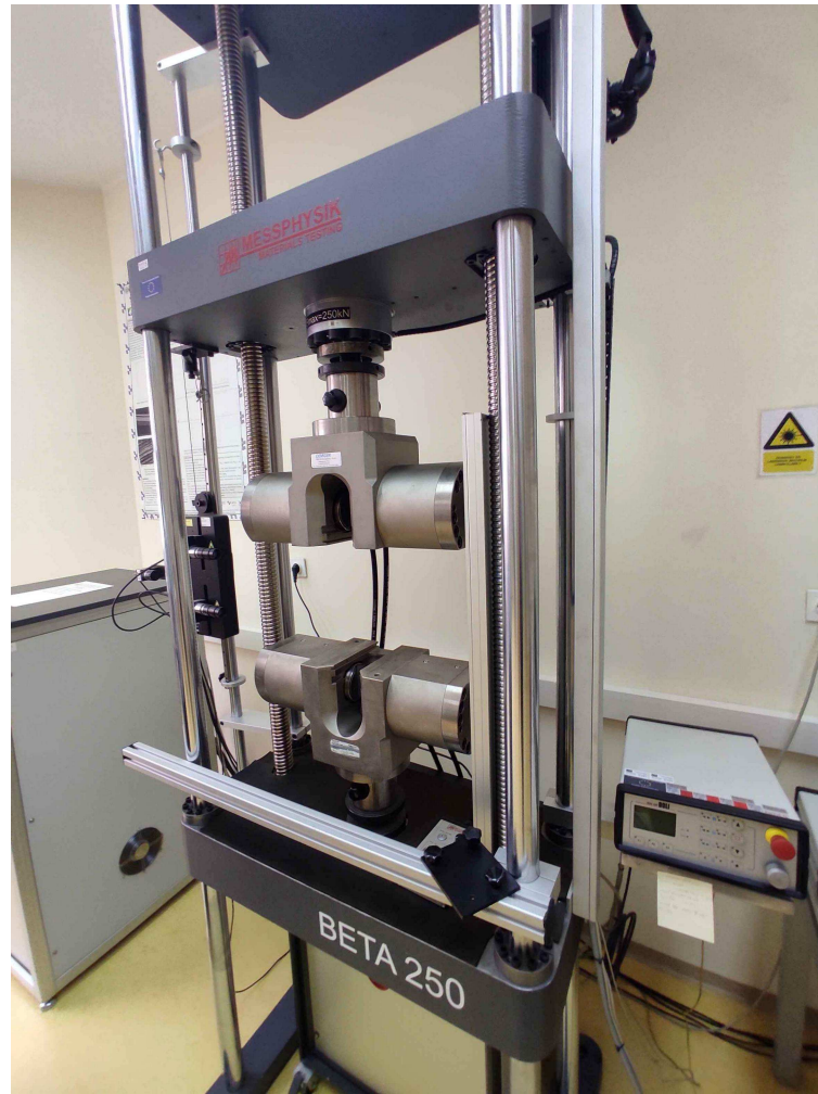
Slika 16: Messphysik Beta 250 univerzalna statička kidalica
