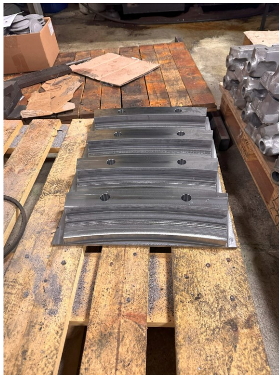
Slika 27. Paleta sa gotovim obradcima
