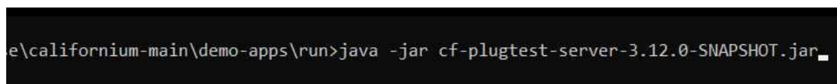
Slika 19. Naredba za pokretanje testnog CoAP servera, koji je dio Eclipse Californium paketa
