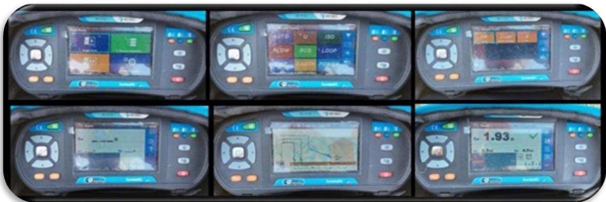
Slika 11: Postupak ispitivanja otpora uzemljenja instrumentom Metrel Eurotest XA
