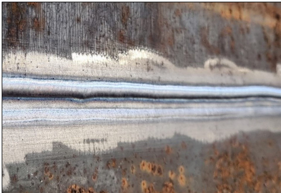
Slika 30. Zavareni spoj (sučeljeno)
