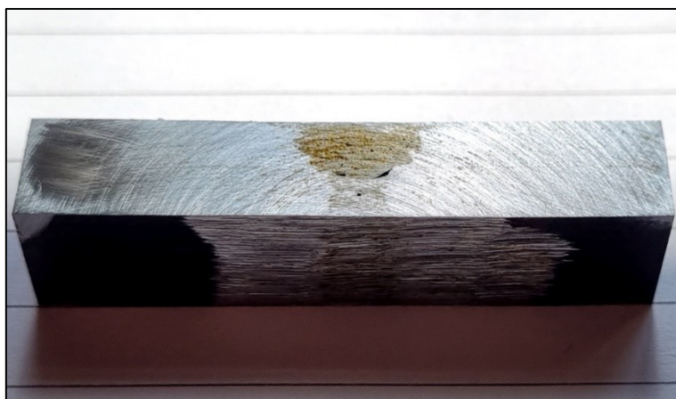
Slika 62. Brušenje (nakon granulacije 4000)
