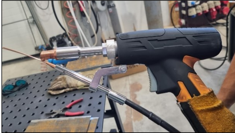
Slika 13. Glava za zavarivanje
