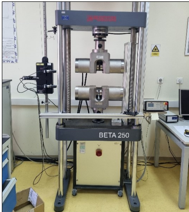
Slika 40. MESSPHYSIK BETA 250 univerzalna statička kidalica
