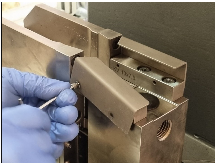
Slika 43. Zamjena držača epruveta (Charpy)
