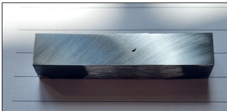
Slika 61. Brušenje (nakon granulacije 1000)
