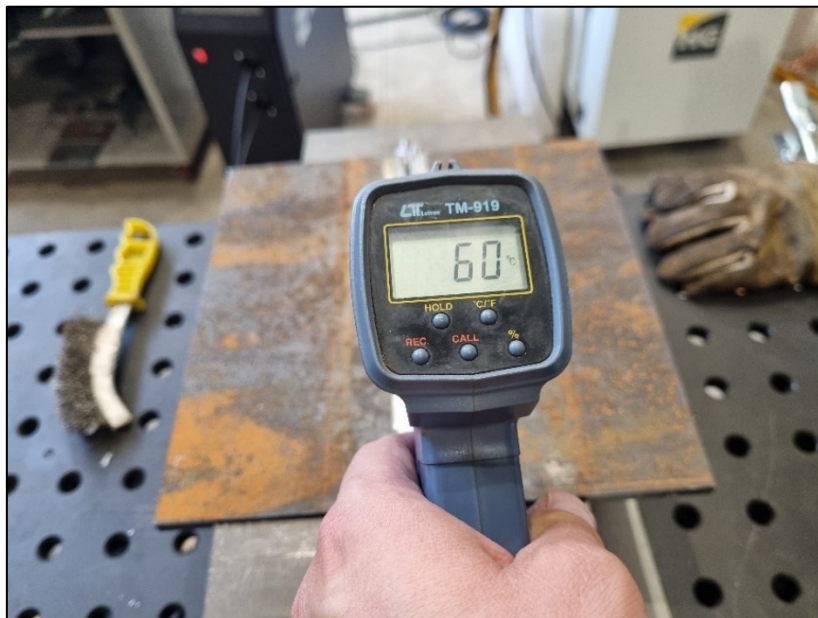
Slika 26. Temperatura nakon 4. i 5. prolaza
