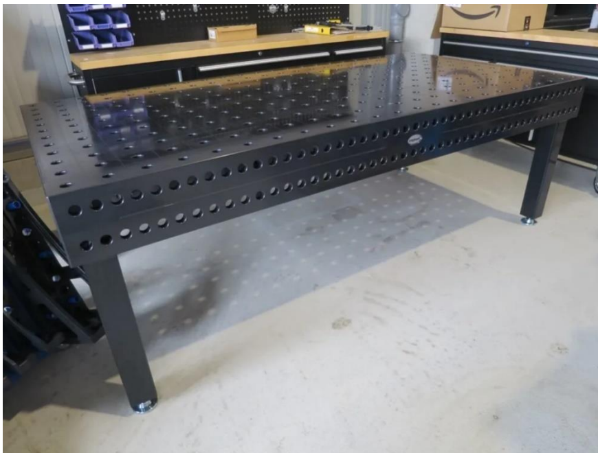
Slika 7. Metalni stol za implementaciju MIG zavarivanja
