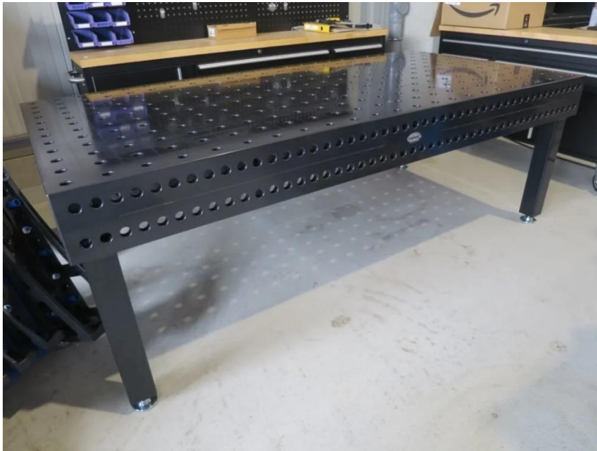
Slika 7. Metalni stol za implementaciju MIG zavarivanja
