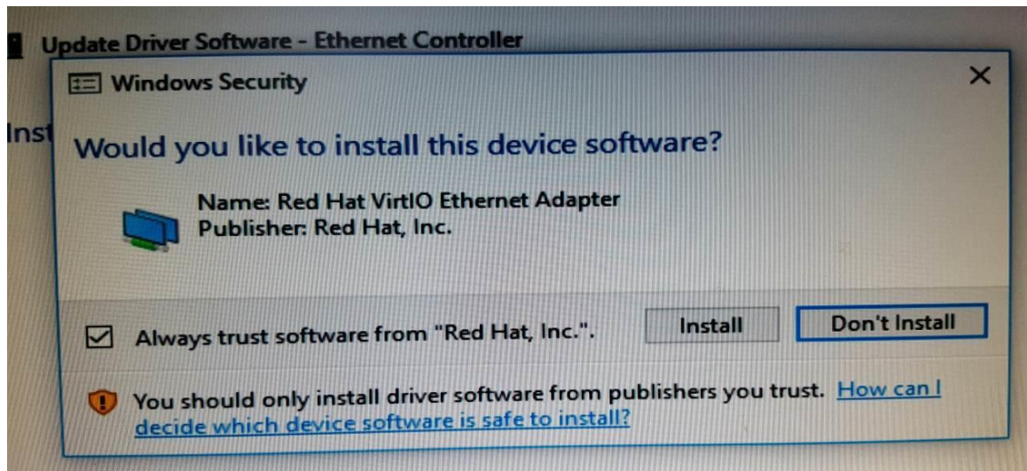
Slika 30 – Instalacija upravljačkog programa za Ethernet sučelje
