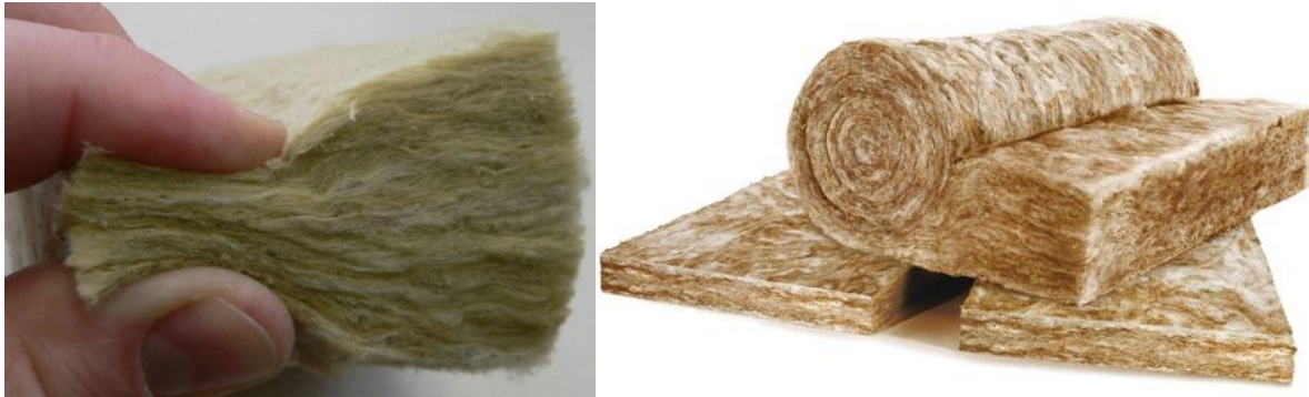
Slika 11. Izgled mineralne vune i staklene vune
