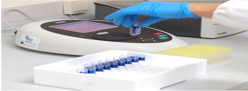
Slika 20. Određivanje antioksidativne aktivnosti ispitivanih uzoraka spektrofometrijskim mjerenjem apsorbancije. Veći antioksidativni kapacitet = jače plavo obojenje (vlastiti izvor)
