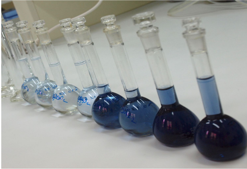
Slika 17. Uzorci pripremljeni za spektrofometrijsko određivanje koncentracije ukupnih neflavonoidnih fenola. Veća koncentracija neflavonoidnih fenola-jače plavo obojenje (vlastiti izvor)
